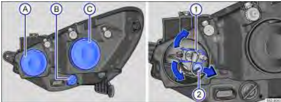
Fig. 173 No compartimento do motor: vista traseira do farol dianteiro direito com cobertura de borracha (esquerda): A farol alto e luz de posição, B indicadores de direção e C farol baixo. Vista traseira do farol dianteiro direito sem cobertura de borracha (direita): 1 farol alto, 2 luz de posição
