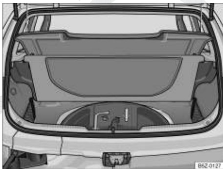
Fig. 158 No compartimento de bagagem embaixo do revestimento do assoalho: ferramentas de bordo.
