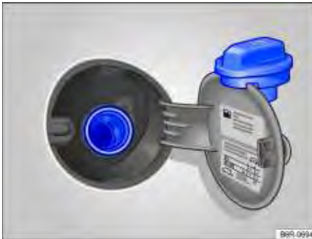
Fig. 124 Portinhola do tanque de combustível aberta com a tampa do tanque de combustível pendurada.
