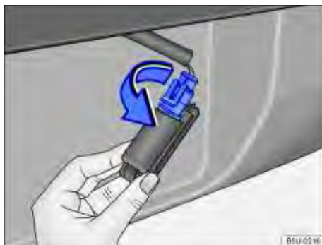
Fig. 182 Lanterna da placa de licença: remover o soquete da lâmpada.
