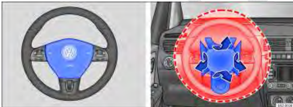
Fig. 55 Local de instalação e área de expansão do airbag frontal do condutor.
