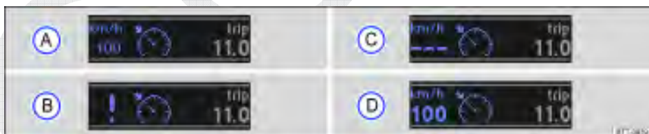
Fig. 117 No display do instrumento combinado: indicadores de status do GRA.
