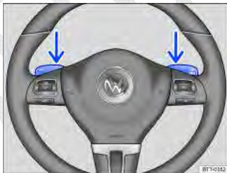
Fig. 103 Volante com dois seletores para troca de marcha no modo manual.
