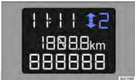
Fig. 99 No instrumento combinado: indicador de troca de marcha (variante 2).
