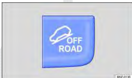
Fig. 111 No console central: botão para ligar e desligar o modo off-road manualmente.
