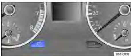
Fig. 62 No instrumento combinado: tecla de regulagem da iluminação dos instrumentos e dos interruptores.
