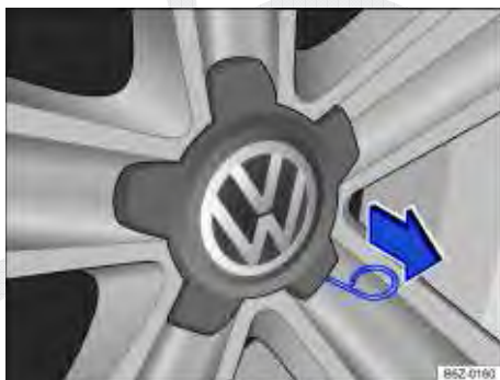
Fig. 163 Retirar a calota central da roda de emergência.
