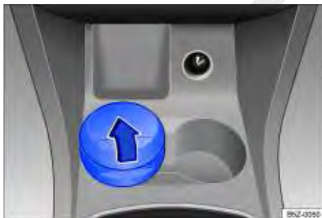
Fig. 89 No console central dianteiro: abrir o cinzeiro.
