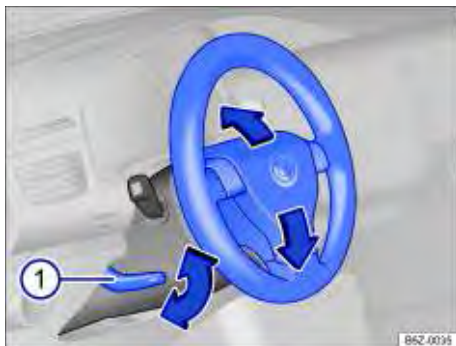
Fig. 42 Ajustar a posição do volante mecanicamente.
