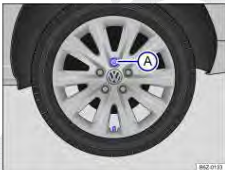
Fig. 161 Retirar a calota integral.
