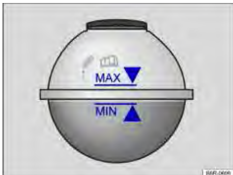
Fig. 130 No compartimento do motor: marcação no reservatório de expansão do líquido de arrefecimento do motor.
