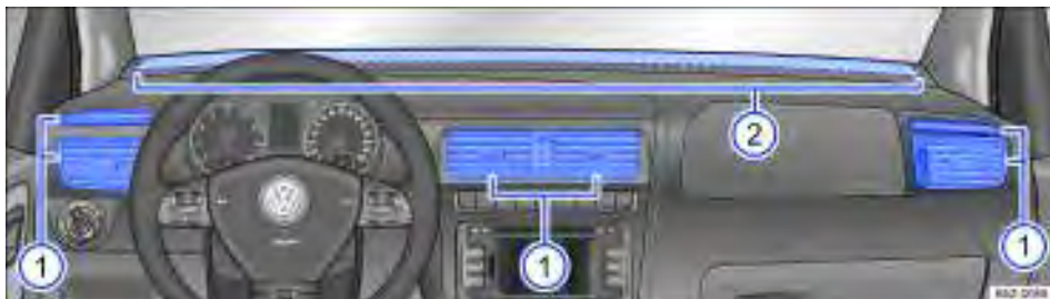
Fig. 121 No painel de instrumentos: difusores de ar.
