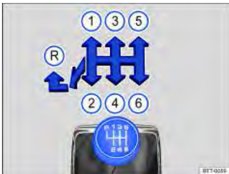
Fig. 97 Esquema de troca de marchas da transmissão manual de 6 marchas.
