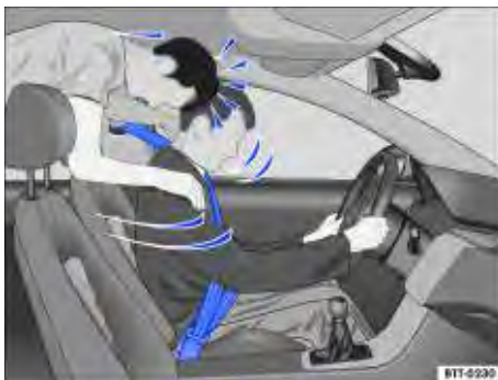
Fig. 47 O passageiro sem cinto de segurança no banco traseiro é lançado para frente sobre o condutor com cinto de segurança.
