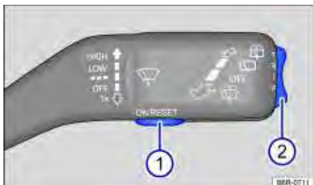
Fig. 12 Veículos sem volante multifunções: Tecla ① na alavanca dos limpadores do para-brisa para confirmação dos itens de menu e chave ② para alternar entre os menus.
