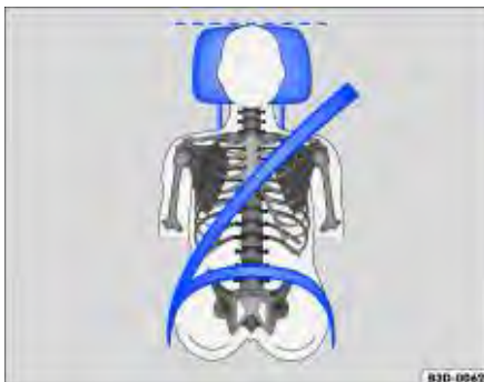
Fig. 36 Posição correta do cadarço do cinto de segurança e ajuste correto do apoio para cabeça.
