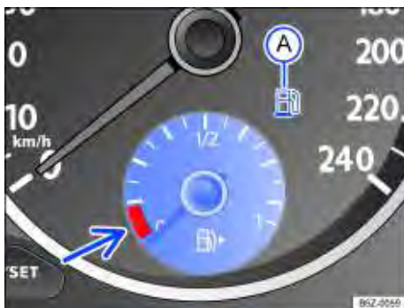
Fig. 123 No instrumento combinado: indicador do nível de combustível
