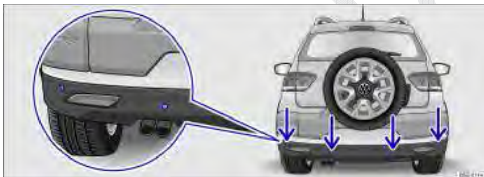
Fig. 114 Sensores de ultrassom do controle de distância de estacionamento no para-choque traseiro.
