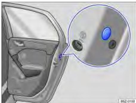
Fig. 153 Na parte dianteira da porta do passageiro dianteiro: travamento de emergência, coberto por uma vedação de borracha.
