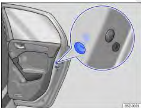
Fig. 59 Na porta traseira (lado direito): localização da trava de segurança para crianças.
