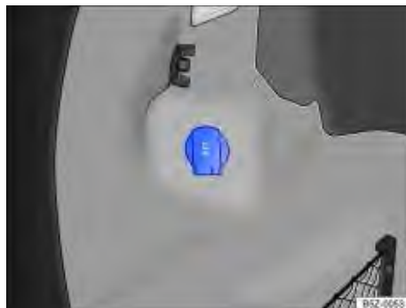
Fig. 92 No compartimento de bagagem: tomada 12 V.
