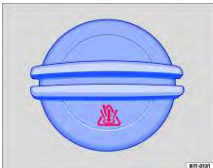
Fig. 131 No compartimento do motor: tampa do reservatório de expansão do líquido de arrefecimento do motor.
