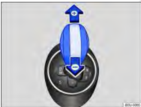
Fig. 102 Alavanca seletora na posição para condução de marcha no modo manual.
