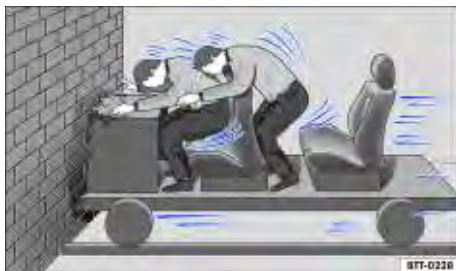
Fig. 45 Um veículo com os ocupantes do veículo sem cintos de segurança colide com o muro.
