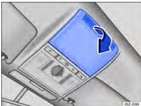
Fig. 156 No revestimento do teto: remover a cobertura.
