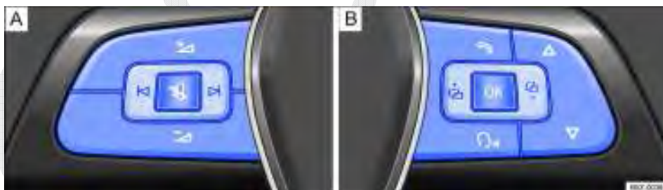
Fig. 16 Volante multifunções: teclas de comando (variante 2)
