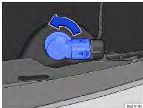
Fig. 180 Atrás do para-choque traseiro: acesso à lâmpada incandescente da lanterna de neblina (somente lado esquerdo).
