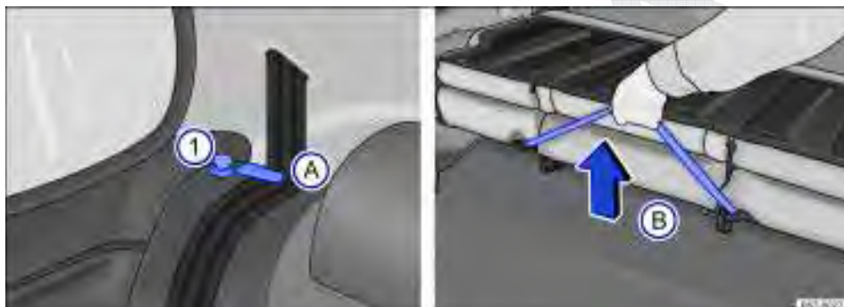
Fig. 74 Banco traseiro: pino de destravamento ①; posicionador para os caderços dos cintos (A); alça para destravamento do conjunto do assoalho (B).
