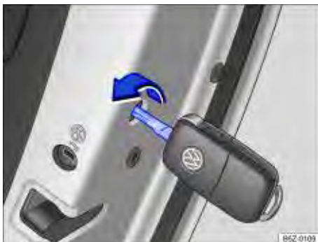
Fig. 154 Travamento de emergência do veículo com a chave do veículo.
