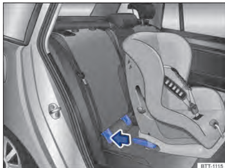
Fig. 4 Representação esquemática: instalar a cadeira de criança ISOFIX com os braços de apoio.
