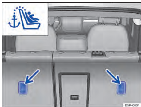
Fig. 5 Olhais de retenção para o cinto de fixação superior no lado de trás do banco traseiro.
