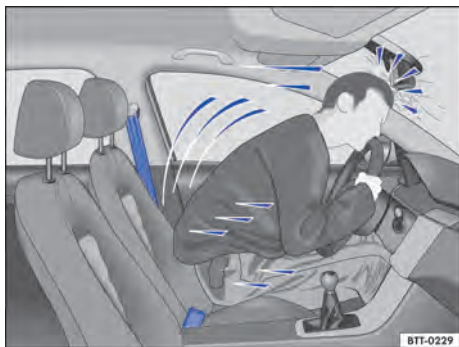
Fig. 74 O condutor sem cinto de segurança é lançado para frente.
