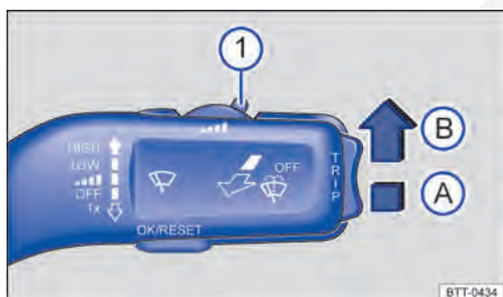
Fig. 102 Na alavanca dos limpadores do para-brisa à direita da coluna de direção: ajustar o sensor de chuva e de luz ①.
