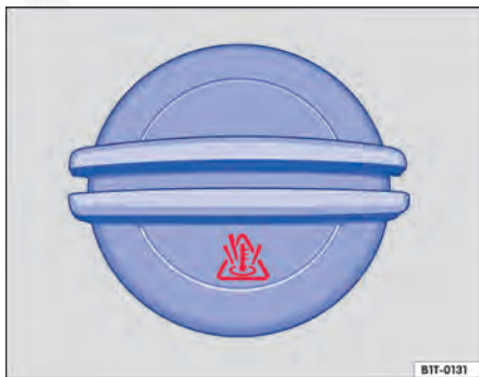
Fig. 193 No compartimento do motor: tampa do reservatório do líquido de arrefecimento do motor.
