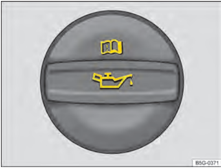
Fig. 190 No compartimento do motor: tampa da abertura de enchimento de óleo do motor.
