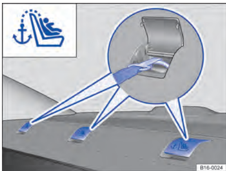
Fig. 93 Nos porta-objetos atrás do encosto do banco traseiro: olhais de retenção para o cinto de fixação superior.
