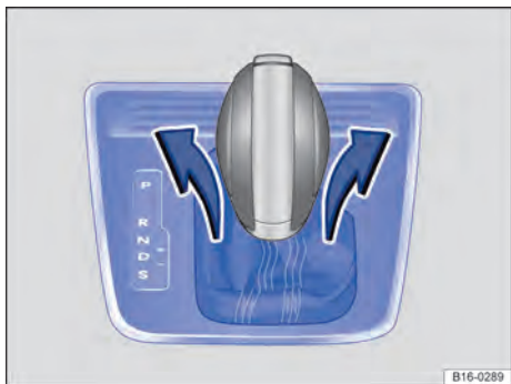
Fig. 215 Desinstalar a cobertura do quadro da alavanca seletora.
