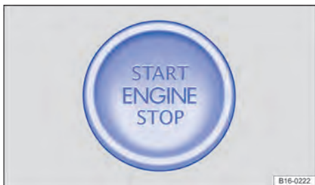
Fig. 141 Na parte inferior do console central: botão de partida do sistema de travamento e de partida Keyless Access.
