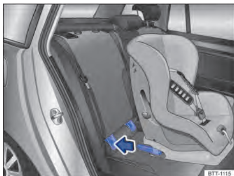
Fig. 92 Representação esquemática: instalar a cadeira de criança ISOFIX com os braços de apoio.
