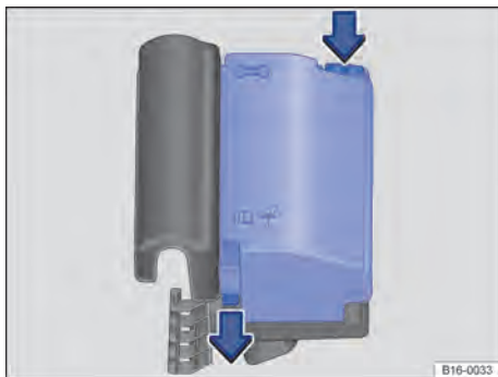
Fig. 230 No compartimento do motor: cobertura da caixa de fusíveis.
