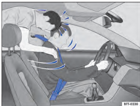
Fig. 75 O passageiro sem cinto de segurança no banco traseiro é lançado para frente sobre o condutor com cinto de segurança.
