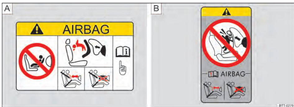
Fig. 89 Representação esquemática: etiqueta do airbag no para-sol [A] ou na coluna B [B].
