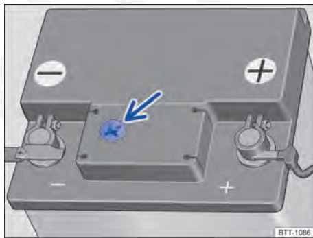
Fig. 28 Representação esquemática: visor no lado superior da bateria do veículo 12 V.
