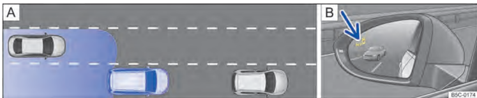
Fig. 170 Representação esquemática: A situação de condução ao ultrapassar com o trânsito traseiro. B indicador do sensor de ponto cego no espelho retrovisor externo esquerdo.
