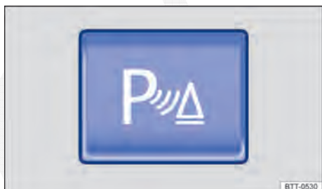
Fig. 159 Na parte inferior do console central: botão para ligar e desligar o Park Pilot.
