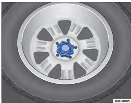
Fig. 201 No compartimento de bagagem: manípulo para fixação da roda sobressalente.
