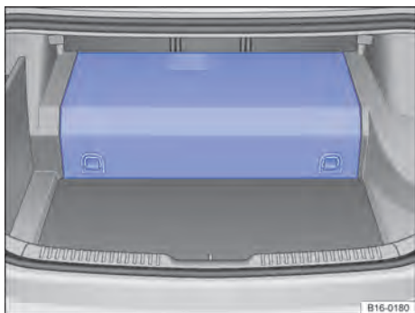
Fig. 24 No compartimento de bagagem: local de instalação da bateria de alta tensão.
