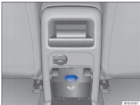
Fig. 138 Na parte traseira do console central: cobertura da tomada Euro de 230 Volt ou de 115 Volt aberta.
