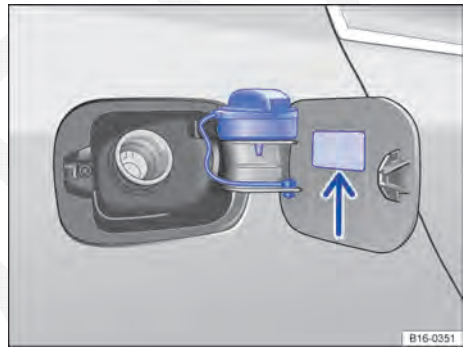
Fig. 23 Portinhola do tanque aberta com a tampa do tanque pendurada.
