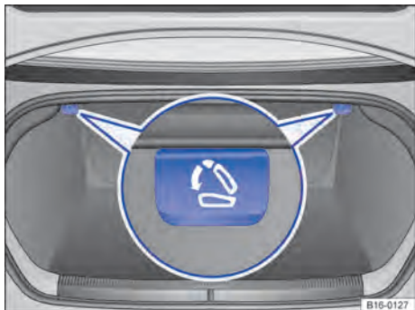
Fig. 109 No compartimento de bagagem: alavanca de destravamento para o encosto do banco traseiro.
