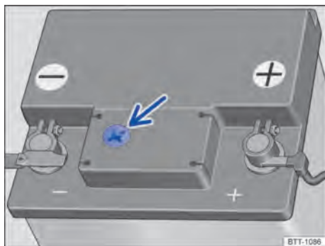
Fig. 195 Representação esquemática: visor no lado superior da bateria do veículo 12 V.
