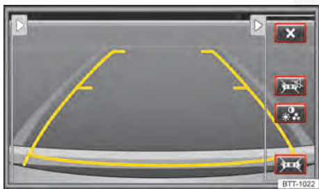
Fig. 163 Exibição do display do rádio ou do sistema de navegação: câmera de marcha a ré ligada.
