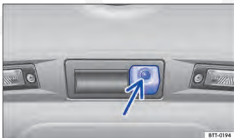
Fig. 162 Na tampa do compartimento de bagagem: local de instalação do assistente de condução em marcha a ré.
