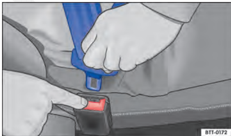
Fig. 78 Soltar a lingueta do cinto de segurança do fecho do cinto de segurança.
