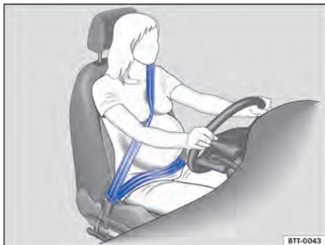
Fig. 80 Posição correta do cadarço do cinto de segurança para mulheres grávidas.
