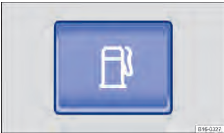
Fig. 22 Na parte inferior do console central: botão para destravar a portinhola do combustível.
