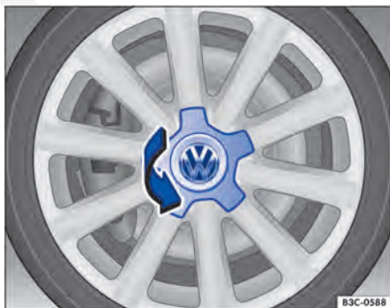
Fig. 220 Virar a calota central.
