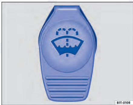
Fig. 104 No compartimento do motor: tampa do reservatório de água dos lavadores do para-brisa.
