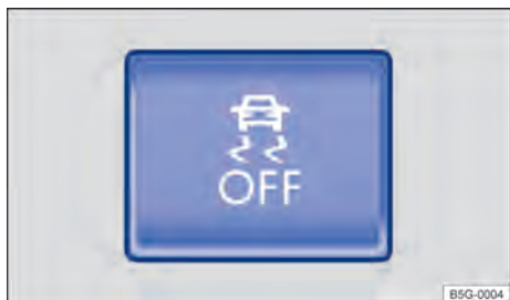
Fig. 153 Na parte inferior do console central: botão para desligar e ligar manualmente o ASR, ASR com ESC ou ESC Sport.
