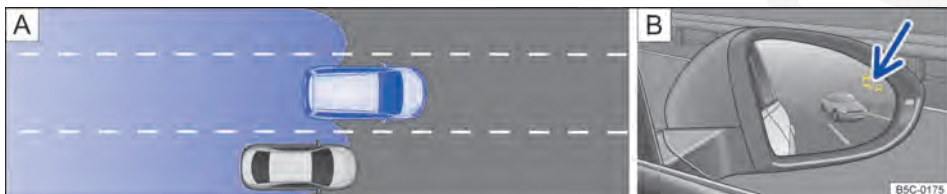
Fig. 171 Representação esquemática: A situação de condução ao ultrapassar e mudar frequentemente de faixa. B indicador do sensor de ponto cego no espelho retrovisor externo direito.
