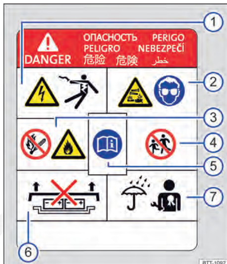
Fig. 25 Placa de advertência na bateria de alta tensão.
