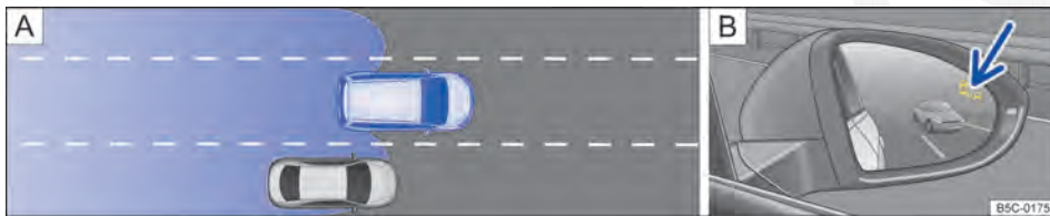
Fig. 184 Representação esquemática: A situação de condução ao ultrapassar e mudar frequentemente de faixa. B indicador do sensor de ponto cego no espelho retrovisor externo direito.
