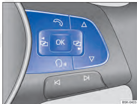
Fig. 14 Lado direito do volante multifunções: botões para comando dos menus e exibições de informação do instrumento combinado.
