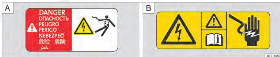
Fig. 17 Placas de advertência (representações esquemáticas): A componente de alta tensão, B placa de advertência geral para alta tensão.
