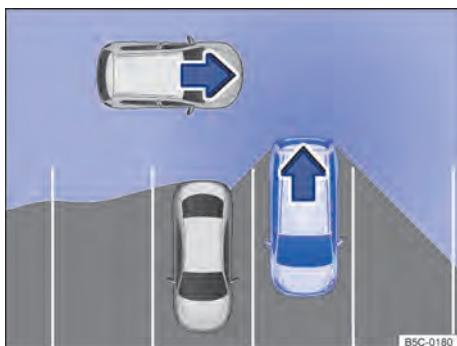
Fig. 185 Representação esquemática do assistente de saída de vaga de estacionamento: área monitorada ao redor do veículo.
