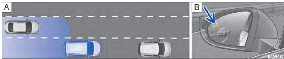
Fig. 183 Representação esquemática: A situação de condução ao ultrapassar com o trânsito traseiro. B indicador do sensor de ponto cego no espelho retrovisor externo esquerdo.
