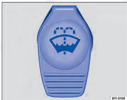
Fig. 106 No compartimento do motor: tampa do reservatório de água dos lavadores do para-brisa.
