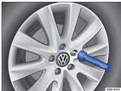
Fig. 245 Troca de roda: desaparafusar os parafusos de roda com o punho da chave de fenda.
