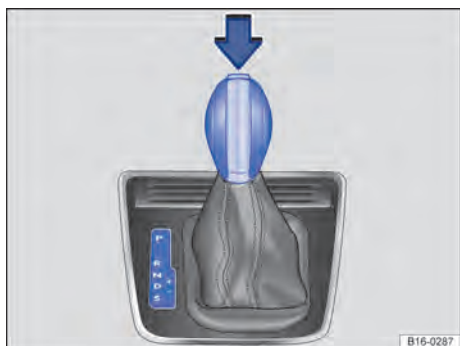
Fig. 148 Veículos com direção à esquerda: alavanca seletora da transmissão automática com botão bloqueador (seta).
