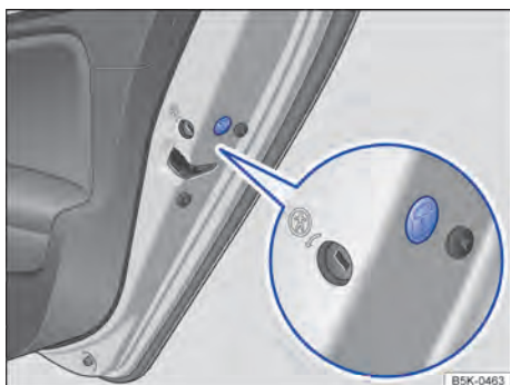
Fig. 225 Na parte dianteira da porta traseira direita: travamento de emergência, coberto por uma vedação de borracha.
