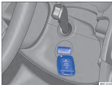
Fig. 142 À direita na coluna de direção: função de partida de emergência em veículos com Keyless Access.
