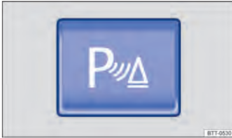
Fig. 159 Na parte inferior do console central: botão para ligar e desligar o Park Pilot.
