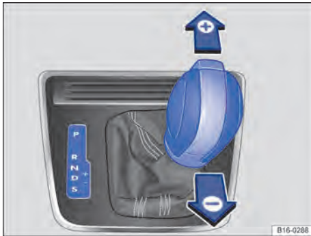
Fig. 150 Alavanca seletora na posição Tiptronic (veículos com direção à esquerda). Veículos com direção à direita são espelhados.
