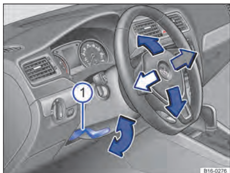
Fig. 66 Embaixo do volante no revestimento da coluna de direção: alavanca de ajuste mecânico da posição do volante.
