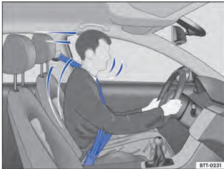
Fig. 77 Condutor protegido pelo cinto de segurança colocado corretamente em uma manobra de frenagem súbita.
