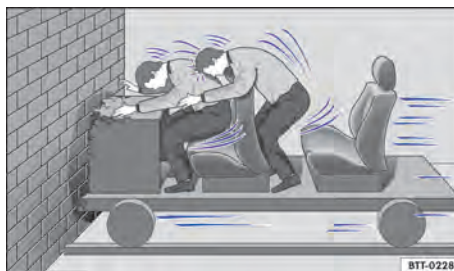
Fig. 25 Um veículo com os ocupantes do veículo sem cintos de segurança colide com um muro.
