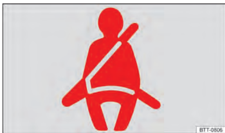
Fig. 23 No display do instrumento combinado: luz de advertência.
