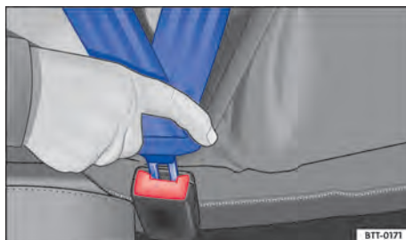
Fig. 29 Introduzir a lingueta do cinto de segurança no fecho do cinto de segurança.
