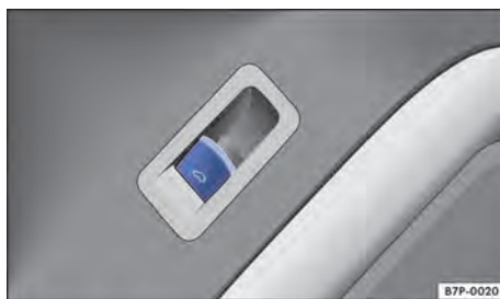
Fig. 65 Na porta do condutor: botão de destravamento da tampa do compartimento de bagagem.
