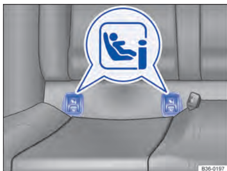
Fig. 45 Identificação dos pontos de ancoragem do i-Size para cadeiras de criança.
