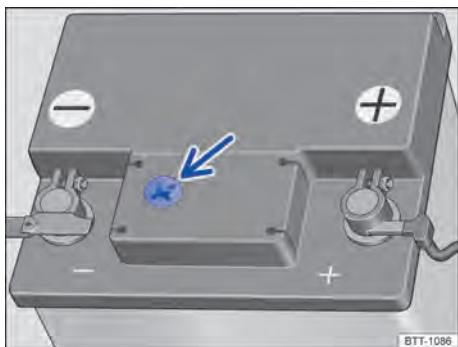
Fig. 171 Visor no lado superior da bateria do veículo 12 V (representação esquemática).
