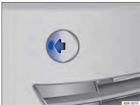
Fig. 159 No para-choque dianteiro à direita: retirar cobertura.
