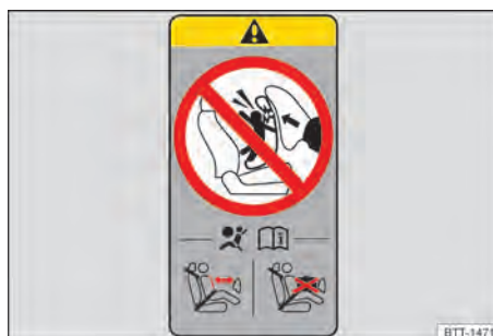
Fig. 43 Representação esquemática: etiqueta do airbag na coluna B.
