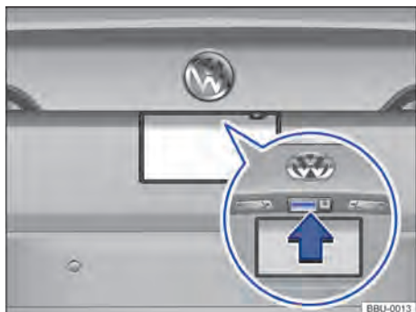
Fig. 66 Na tampa do compartimento de bagagem: botão para abrir a tampa do compartimento de bagagem.
