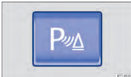
Fig. 127 No console central: botão para ligar ou desligar o auxílio de estacionamento.
