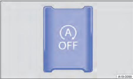
Fig. 104 Na parte inferior do console central: botão do sistema Start-Stop.
