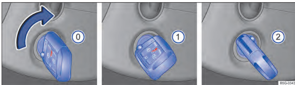
Fig. 101 Ao lado do volante à direita: posições da chave do veículo no cilindro da ignição.
