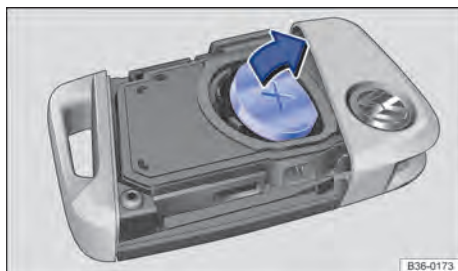
Fig. 56 Chave do veículo: substituir a pilha-botão.
