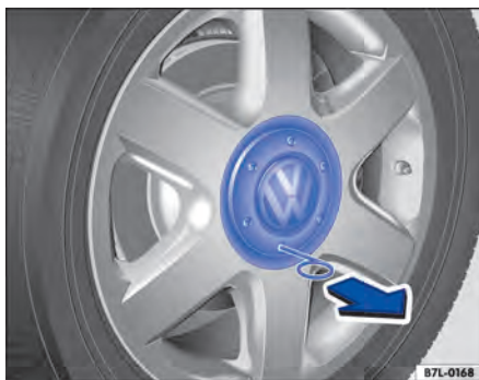
Fig. 177 Retirar a calota central.
