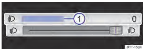
Fig. 87 No sistema Infotainment; regulador deslizante para regulagem do alcance do farol.
