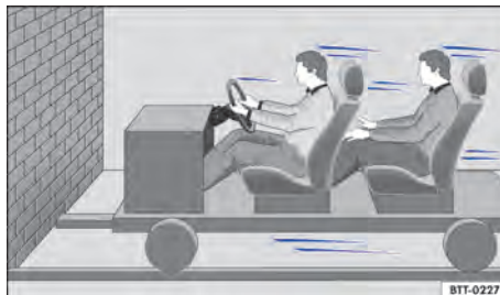
Fig. 24 Um veículo com os ocupantes do veículo sem cintos de segurança está em rota de colisão com um muro.
