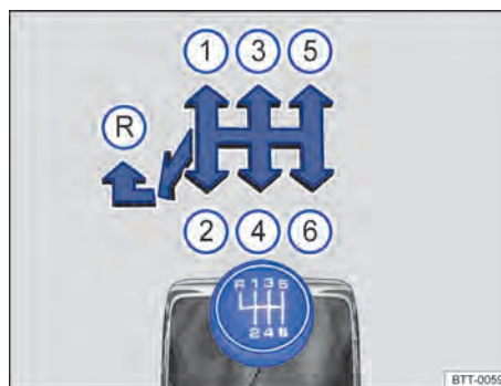
Fig. 105 Esquema de troca de marchas da transmissão manual de 6 marchas.
