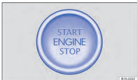
Fig. 102 Na parte inferior do console central: botão de partida para ligar o motor.
