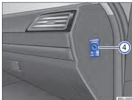
Fig. 10 Com a porta do passageiro aberta (veículo com direção à esquerda): interruptor de chave no painel de instrumentos (em veículos com direção à direita, a disposição dos elementos é espelhada).
