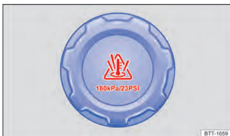
Fig. 168 No compartimento do motor: tampa do reservatório de expansão do líquido de arrefecimento (representação esquemática).
