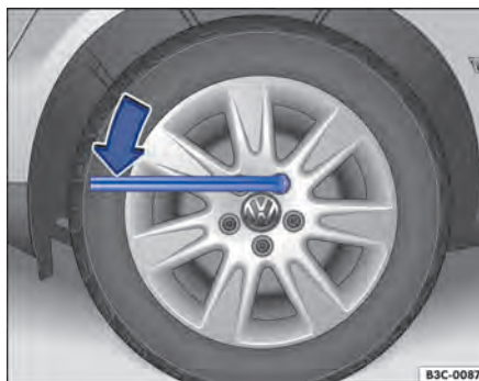
Fig. 181 Troca de roda: afrouxar os parafusos de roda.
