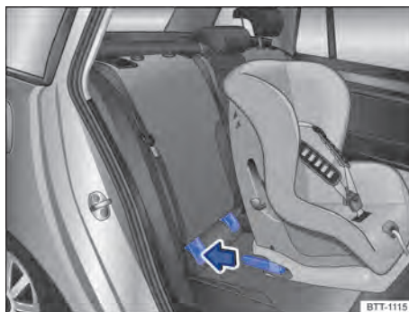
Fig. 46 Representação esquemática: instalar a cadeira de criança com braços de apoio.
