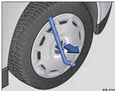
Fig. 179 Retirar a calota integral.
