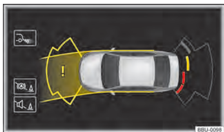
Fig. 126 No display do sistema Infotainment: indicação do auxílio de estacionamento.
