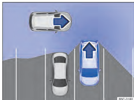
Fig. 129 Representação esquemática do assistente de saída de vaga: área monitorada ao redor do veículo.
