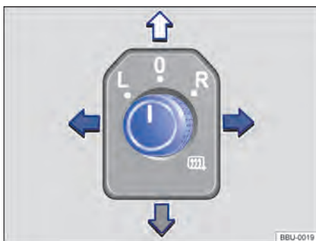
Fig. 92 Na porta do condutor: botão rotativo dos espelhos retrovisores externos.
