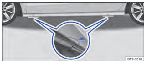
Fig. 188 Pontos de apoio do macaco
