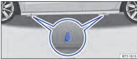
Fig. 186 Pontos de apoio do macaco
