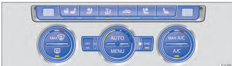
Fig. 95 Na parte superior do console central: painel de comando do ar-condicionado do Climatronic.
