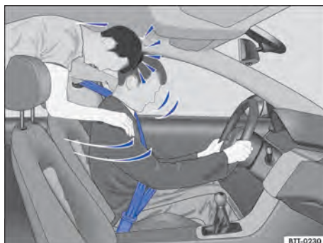
Fig. 27 O passageiro sem cinto de segurança no banco traseiro é lançado para frente sobre o condutor com cinto de segurança.
