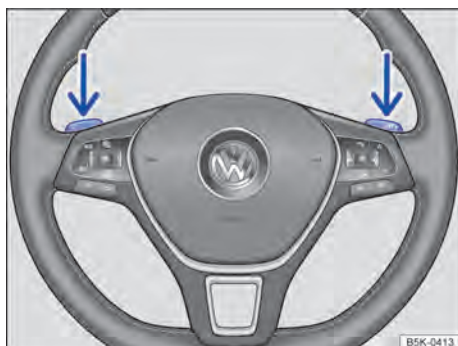
Fig. 108 Volante com seletores basculantes do Tiptronic.
