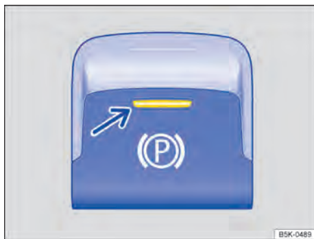
Fig. 124 No console central: botão do freio de estacionamento eletrônico (representação esquemática).
