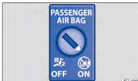
Fig. 37 No painel de instrumentos no lado do passageiro dianteiro: interruptor acionado pela chave para desligar e ligar o airbag do passageiro dianteiro.
