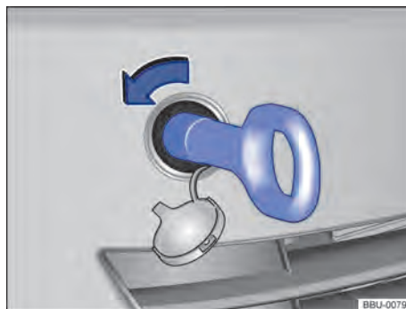
Fig. 160 No para-choque dianteiro à direita: rosquear a argola de reboque.
