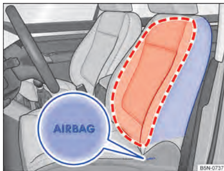
Fig. 39 Lateralmente no banco dianteiro: local de instalação e área de expansão dos airbags laterais.
