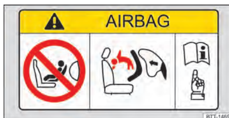
Fig. 42 Representação esquemática: etiqueta do airbag no para-sol.
