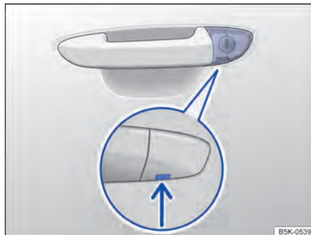
Fig. 60 Maçaneta da porta do condutor: cilindro da fechadura encoberto.
