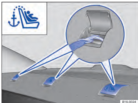
Fig. 47 Na superfície atrás do banco traseiro: olhais de retenção para o cinto de fixação superior.
