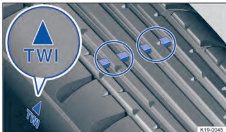
Fig. 175 Perfil do pneu: indicador de desgaste.
