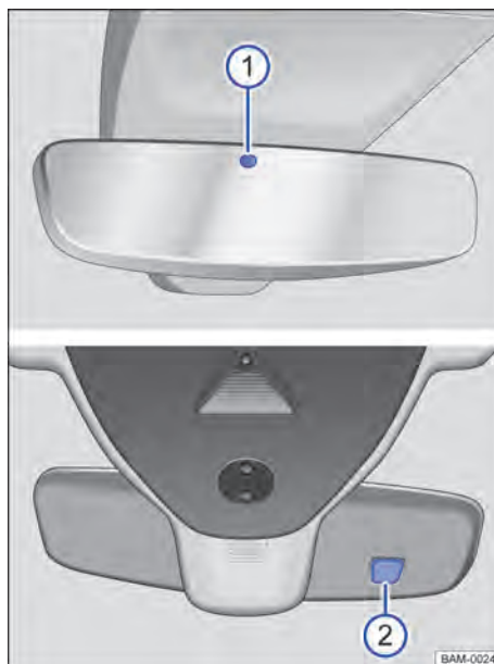
Fig. 90 No para-brisa: espelho retrovisor interno com antiofuscante automático.
