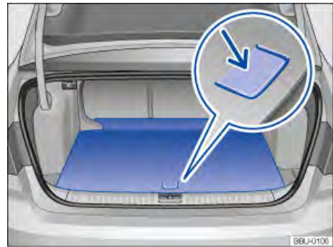
Fig. 138 No compartimento de bagagem: abrir o assoalho do compartimento de bagagem.
