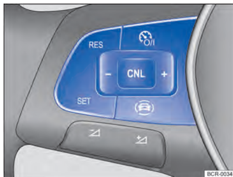
Fig. 116 Lado esquerdo do volante multifunções: botões para comandar o limitador de velocidade.
