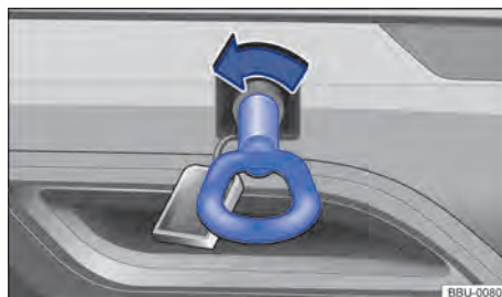
Fig. 158 No para-choque traseiro à direita: rosquear a argola de reboque.
