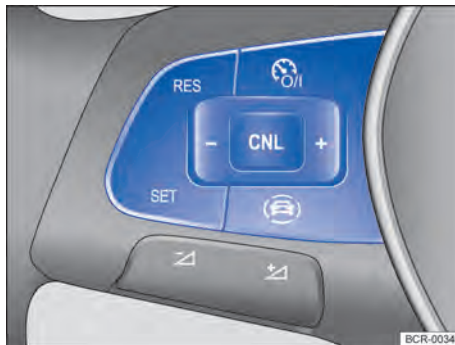
Fig. 114 Lado esquerdo do volante multifunções: botões para comandar o GRA.
