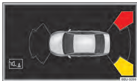
Fig. 130 Na tela do sistema Infotainment: exibição do assistente de saída de vaga (dependendo da versão).
