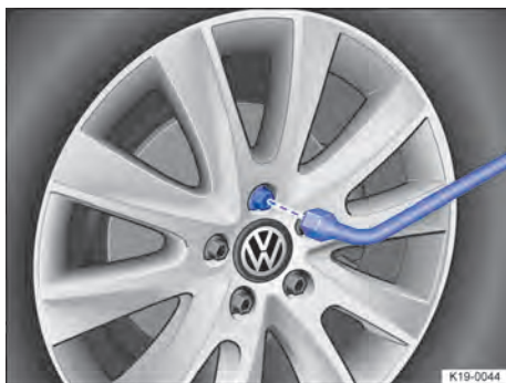
Fig. 190 Troca de roda: desaparafusar os parafusos de roda com a chave de roda.
