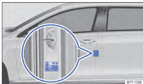
Fig. 174 Na coluna do condutor: etiqueta com as pressões dos pneus (alternativa ao lado interno da portinhola do tanque).
