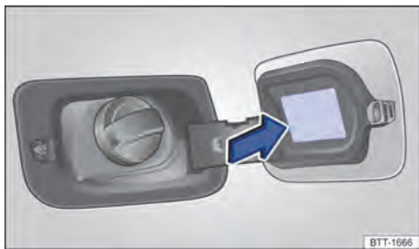
Fig. 197 Na parte interna da portinhola do tanque de combustível: etiqueta com a pressão dos pneus.
