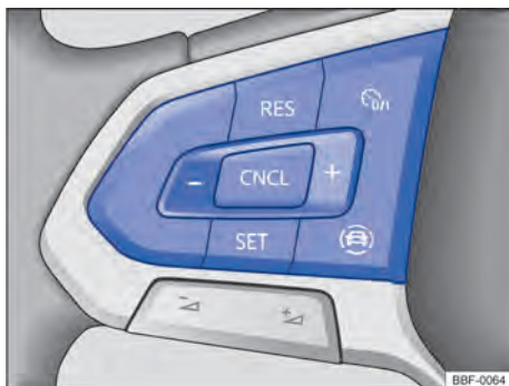
Fig. 100 Lado esquerdo do volante multifunções (variante 2): botões para comandar o limitador de velocidade.
