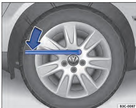
Fig. 203 Troca de roda: soltar os parafusos da roda.
