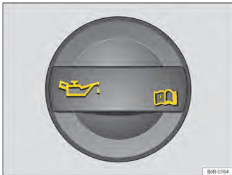
Fig. 189 No compartimento do motor: tampa da abertura para enchimento de óleo do motor.
