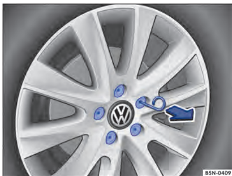
Fig. 202 Remover as capas de cobertura dos parafusos de roda.
