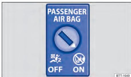
Fig. 39 No painel de instrumentos no lado do passageiro dianteiro: interruptor acionado pela chave para desligar e ligar o airbag frontal do passageiro dianteiro.
