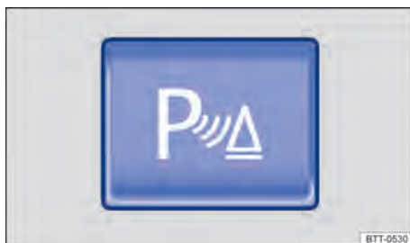
Fig. 89 Na parte superior do console central: botão para ligar e desligar o controle de distância de estacionamento (Park Pilot). ▶
