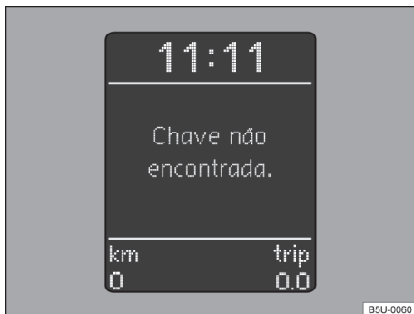
Fig. 83 No instrumento combinado: display com indicação do imobilizador ativado - veículos com Sistema de Informações Volkswagen.
