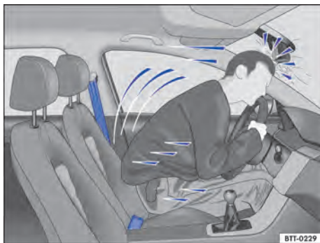
Fig. 26 O condutor sem cinto de segurança é lançado para frente.
