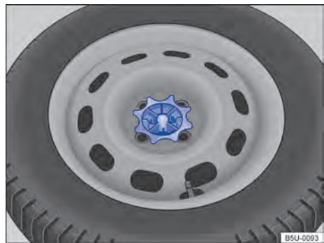
Fig. 197 No compartimento de bagagem: manipulador para fixação da roda de emergência.
