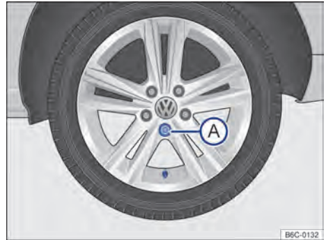
Fig. 203 Troca de roda: sequência de remoção dos parafusos da roda.
