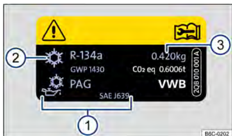
Fig. 207 Informações do ar-condicionado - motor 1.0L TSI, motor 1.4L TSI e motor 1.6L.
