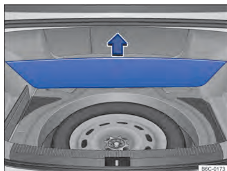
Fig. 157 No compartimento de bagagem, sob o revestimento de assoalho: roda de emergência e ferramentas de bordo.
