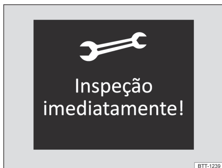
Fig. 17 No display do instrumento combinado: exemplo de indicação para um evento de serviço próximo de vencer (representação esquemática).
