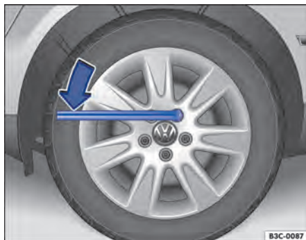
Fig. 200 Troca de roda: soltar os parafusos da roda.
