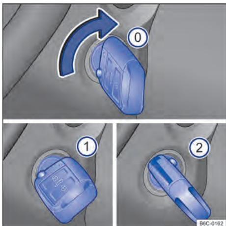
Fig. 87 Ao lado do volante, à direita: posições da chave do veículo no cilindro da ignição.
