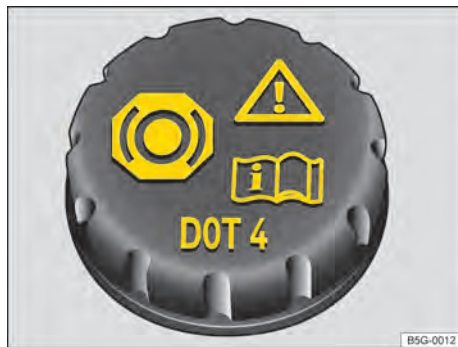
Fig. 190 No compartimento do motor: tampa do reservatório de fluido de freio.
