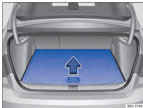
Fig. 150 No compartimento de bagagem: levantar o assoalho variável do compartimento de bagagem.
