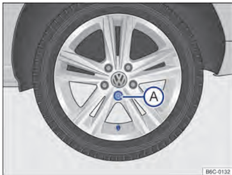
Fig. 199 Retirar a calota integral.
