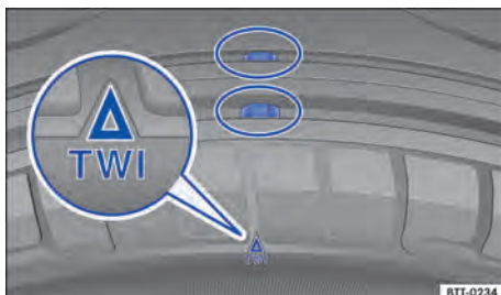
Fig. 196 Perfil do pneu: indicadores de desgaste.
