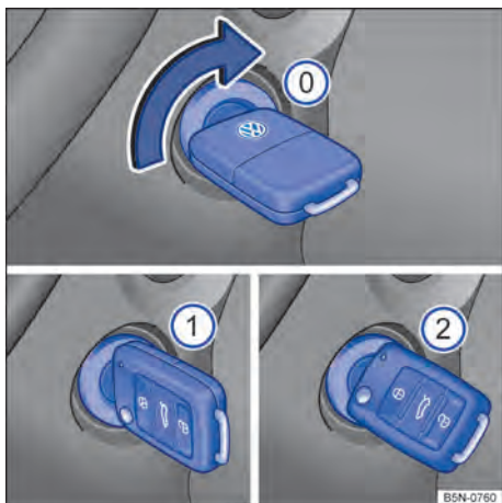
Fig. 79 Ao lado do volante, à direita: posições da chave do veículo no cilindro da ignição.
