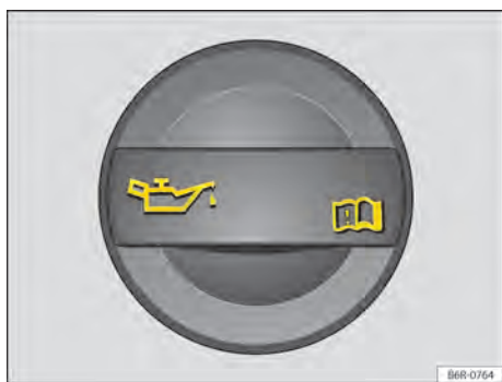
Fig. 171 No compartimento do motor: tampa da abertura para enchimento de óleo do motor.
