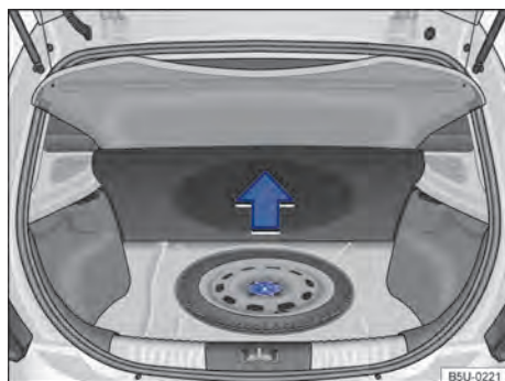
Fig. 143 No compartimento de bagagem, sob o revestimento de assoalho: roda de emergência e ferramentas de bordo.
