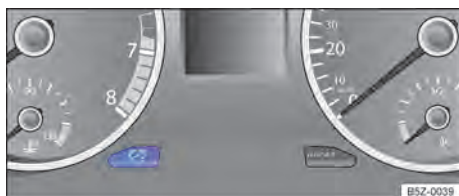
Fig. 64 No instrumento combinado: tecla de regulação da iluminação dos instrumentos e dos interruptores.
