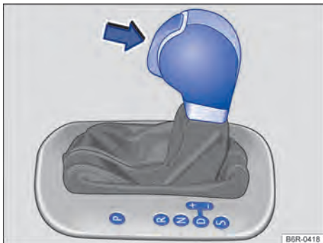
Fig. 82 Alavanca seletora da transmissão automática com botão bloqueador (seta).
