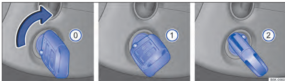
Fig. 117 Posições da chave do veículo no cilindro da ignição.
