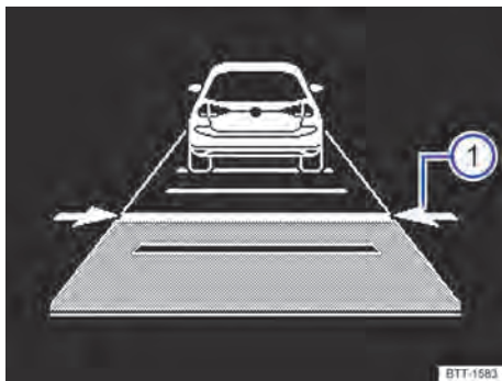
Fig. 143 No display do instrumento combinado: regular a distância (representação esquemática, ACC está regulando).
