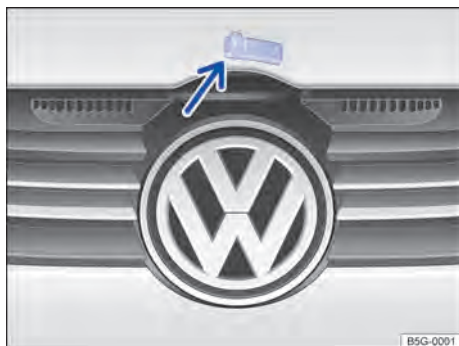
Fig. 223 Alavanca de destravamento para abrir a tampa do compartimento do motor na grade do radiador.
