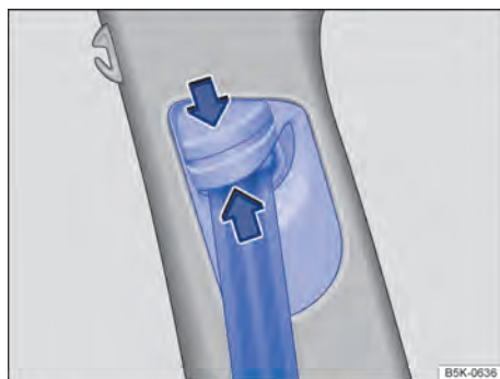
Fig. 39 Ao lado dos bancos dianteiros: regulagem de altura do cinto de segurança. ▶
