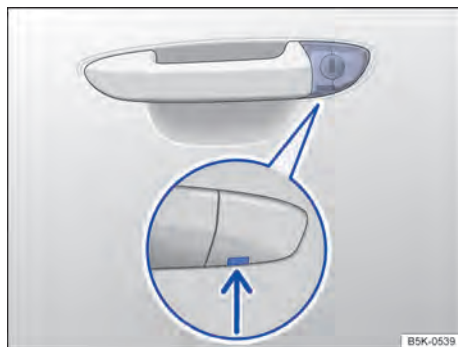
Fig. 69 Maçaneta da porta do condutor: cilindro da fechadura coberto.
