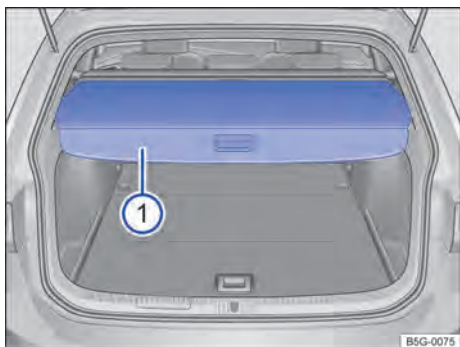
Fig. 174 No compartimento de bagagem: abrir e fechar a cobertura do compartimento de bagagem.
