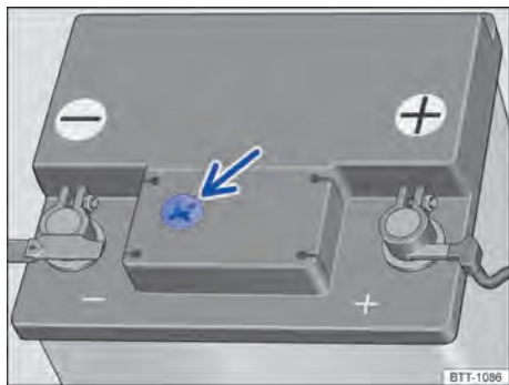
Fig. 231 Representação esquemática: visor no lado superior da bateria do veículo 12 V.
