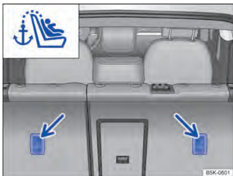
Fig. 54 Olhais de retenção para o cinto de fixação superior no lado de trás do banco traseiro.
