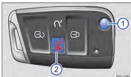
Fig. 58 Chave do veículo com botão do alarme.
