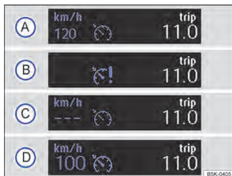
Fig. 135 No display do instrumento combinado: indicadores de status do GRA (representação esquemática).
