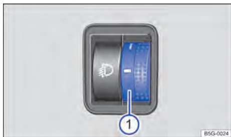
Fig. 94 Ao lado do volante: regulador da regulagem de alcance do farol ①.
