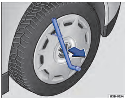
Fig. 240 Retirar a calota integral.
