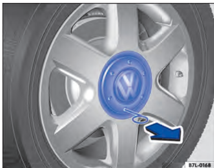
Fig. 238 Retirar a calota central.
