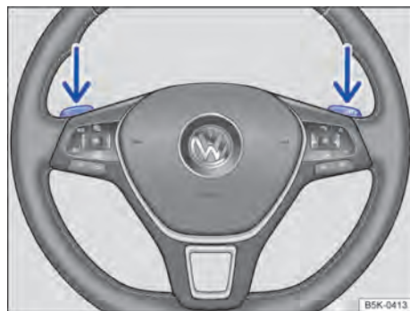
Fig. 125 Volante com seletores basculantes do Tiptronic.
