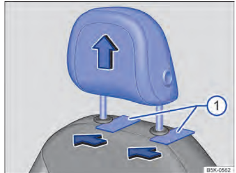
Fig. 88 Desinstalar o apoio para cabeça dianteiro.
