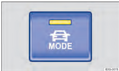
Fig. 128 Na parte inferior do console central: botão de seleção do perfil de condução.
