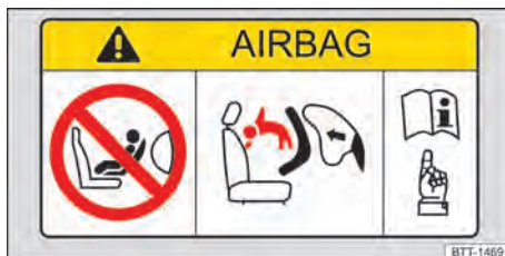
Fig. 49 Etiqueta do airbag no para-sol (representação esquemática).
