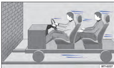
Fig. 30 Um veículo com os ocupantes do veículo sem cintos de segurança está em rota de colisão com um muro.
