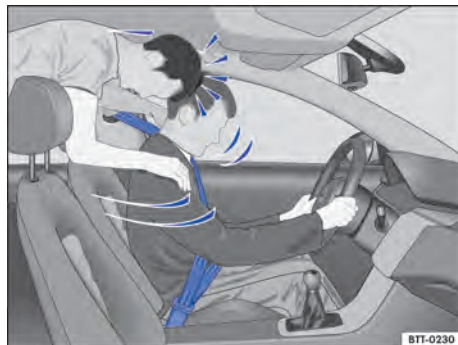
Fig. 33 O passageiro sem cinto de segurança no banco traseiro é lançado para frente sobre o condutor com cinto de segurança.
