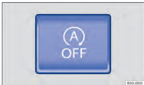
Fig. 120 Na parte inferior do console central: botão do sistema Start-Stop.
