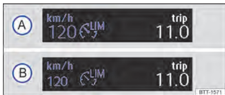
Fig. 137 No display do instrumento combinado: indicadores de status do limitador de velocidade (representação esquemática).
