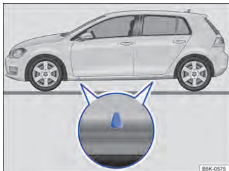
Fig. 244 Pontos de apoio do macaco.
