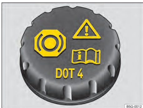
Fig. 224 No compartimento do motor: Tampa do reservatório de fluido de freio (versão 1).
