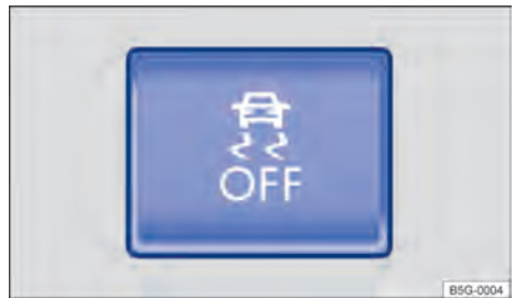
Fig. 157 No controle central: botão para desligar e ligar o ASR manualmente.
