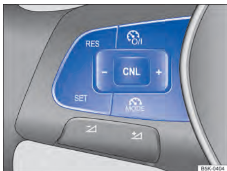
Fig. 134 Lado esquerdo do volante multifunções: botões para comandar o GRA.
