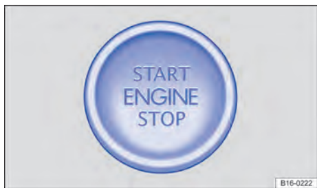
Fig. 118 Na parte inferior do console central: botão de partida do sistema de travamento e de partida Keyless Access.
