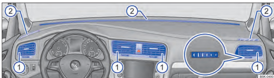
Fig. 111 No painel de instrumentos: difusores de ar.
