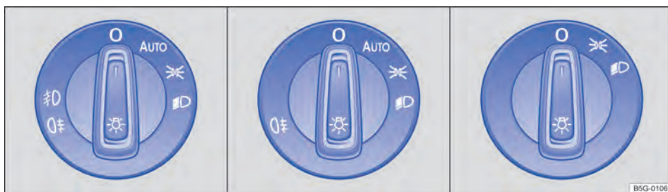
Fig. 92 Ao lado do volante: representação de algumas variantes do interruptor das luzes.
