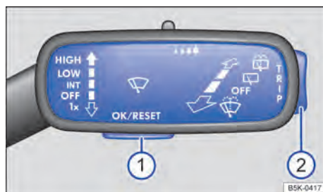
Fig. 21 À direita na coluna de direção: botões na alavanca dos limpadores dos vidros (representação esquemática).
