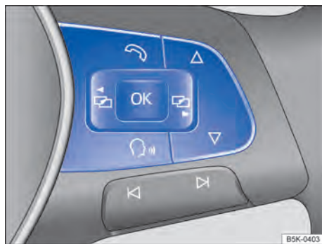
Fig. 22 Lado direito do volante multifunções: botões para comando dos menus e exibições de informação do instrumento combinado.
