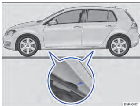
Fig. 246 Pontos de apoio do macaco.
