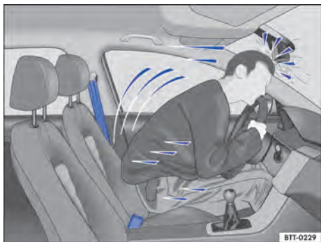
Fig. 32 O condutor sem cinto de segurança é lançado para frente.
