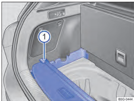
Fig. 176 Embaixo do assoalho do compartimento de bagagem variável: guardar a cobertura do compartimento de bagagem.
