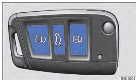
Fig. 62 Chave do veículo: travamento central.
