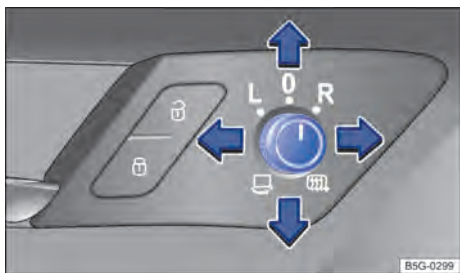
Fig. 106 Na porta do condutor: botão rotativo dos espelhos retrovisores externos.
