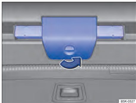
Fig. 75 Na tampa do compartimento de bagagem: abrir o suporte para o triângulo de segurança.
