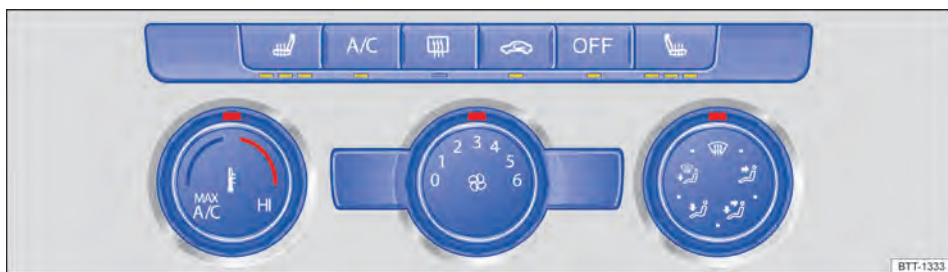
Fig. 109 Na parte superior do console central: comandos do ar-condicionado manual.
