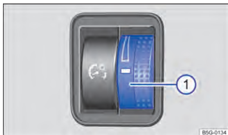
Fig. 95 Ao lado do volante: regulador da iluminação dos instrumentos e dos interruptores ①.
