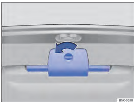
Fig. 56 Na tampa do compartimento de bagagem: suporte para o triângulo de segurança.
