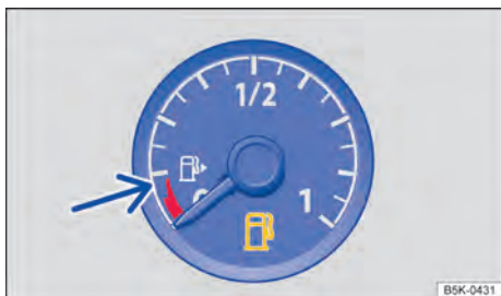
Fig. 17 No instrumento combinado: indicador do nível de combustível.
