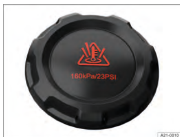
Fig. 193 No compartimento dianteiro: tampa do reservatório de expansão do líquido de arrefecimento (representação esquemática).
