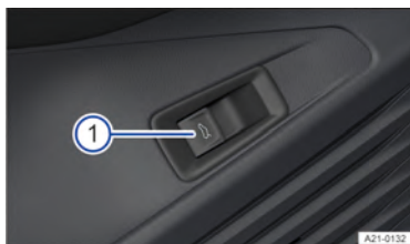
Fig. 62 Na porta do condutor: botão de destravamento da tampa traseira.
