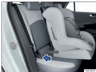
Fig. 37 Representação esquemática: instalar a cadeira de criança com braços de apoio.
