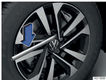
Fig. 208 Troca de roda: desaparafusar os parafusos de roda com a chave de roda.
