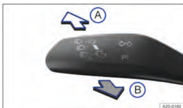
Fig. 82 À esquerda na coluna de direção: alavanca dos indicadores de direção e do farol alto.
