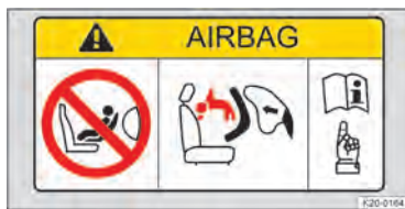
Fig. 35 Representação esquemática: etiqueta do airbag no para-sol.
