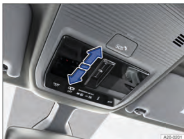
Fig. 92 No revestimento do teto: superfície de função para controle da cortina de proteção solar.
