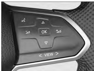
Fig. 10 Lado direito do volante multifunções: operar o instrumento combinado digital.
