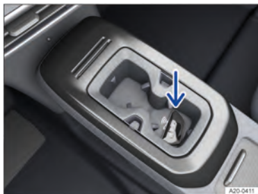
Fig. 95 No console central: função de partida de emergência.
