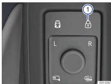
Fig. 54 Na porta do condutor: painel de controle para travamento central.
