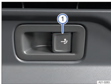
Fig. 143 No compartimento de bagagem, à direita: botão para destravamento do dispositivo de reboque.
