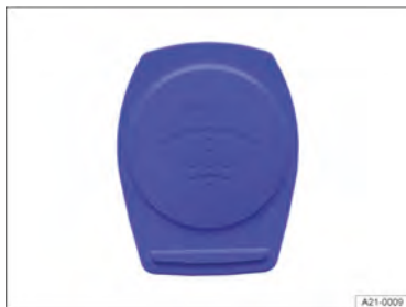
Fig. 192 No compartimento dianteiro: tampa do reservatório de água dos lavadores dos vidros (representação esquemática).
