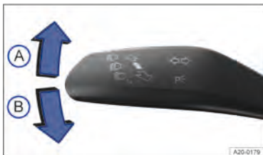
Fig. 80 À esquerda na coluna de direção: alavanca dos indicadores de direção e do farol alto.
