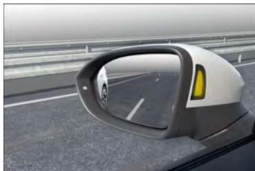
Fig. 111 Na carcaça dos espelhos retrovisores externos: exibições visuais do assistente de mudança de faixa.
