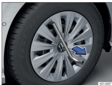
Fig. 201 Retirar a calota integral.
