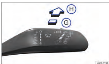
Fig. 87 À direita da coluna de direção: comandar o limpador do vidro traseiro.
