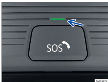
Fig. 43 No console do teto: botão para serviço de chamada de emergência (atrás da cobertura dos botões) e luz de controle.
