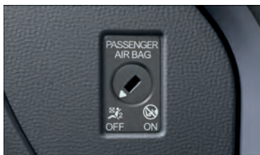
Fig. 27 No painel de instrumentos no lado do passageiro dianteiro: interruptor acionado pela chave para desligar e ligar o airbag frontal do passageiro dianteiro.
