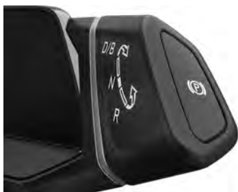
Fig. 112 No seletor da posição de marcha: botão ⓘ do freio de estacionamento eletrônico (representação esquemática).
