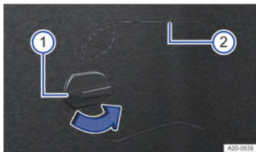
Fig. 158 Revestimento do compartimento de bagagem inferior direito: tampa do destravamento de emergência.
