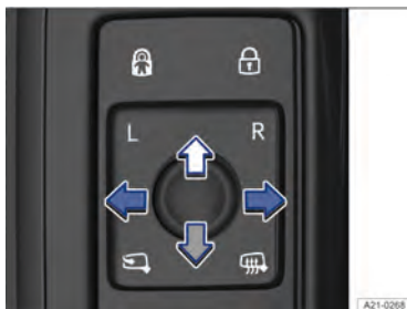
Fig. 90 Na porta do condutor: botão rotativo dos espelhos retrovisores externos.
