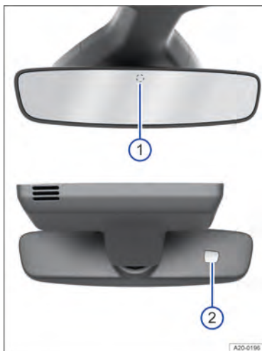
Fig. 89 No para-brisa: espelho retrovisor interno com antiofusco automático.
