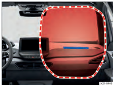
Fig. 26 No lado do passageiro dianteiro: local de instalação e área de expansão do airbag frontal do passageiro dianteiro.
