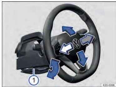
Fig. 67 Embaixo do volante no revestimento da coluna de direção: alavanca de ajuste mecânico da posição do volante (representação esquemática).
