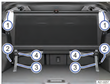
Fig. 136 No compartimento de bagagem: rede divisória instalada atrás do banco traseiro.
