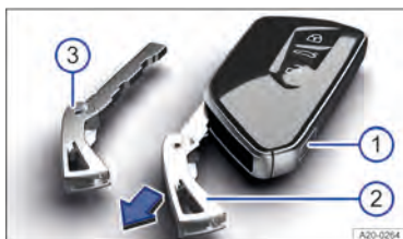
Fig. 49 Chave do veículo: destravamento da chave de emergência.
