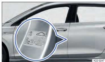
Fig. 197 Na coluna do condutor: etiqueta com as pressões dos pneus (alternativa no lado interno da tampa do carregamento da bateria).
