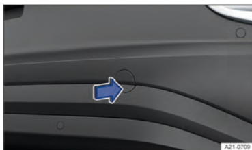
Fig. 185 No para-choque traseiro à direita: remover cobertura.
