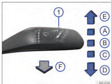
Fig. 86 À direita da coluna de direção: comandar os limpadores do para-brisa.
