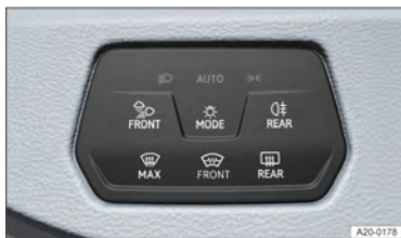
Fig. 81 Ao lado do volante: painel de controle para ligar a iluminação de condução.
