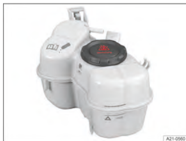
Fig. 194 No compartimento dianteiro: marcações no reservatório de expansão do líquido de arrefecimento (representação esquemática).
