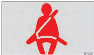
Fig. 18 No display do instrumento combinado: luz de advertência.
