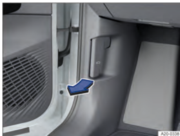
Fig. 187 Na área para os pés no lado do condutor: alavanca de destravamento da tampa dianteira (representação esquemática).
