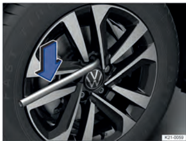
Fig. 203 Troca de roda: afrouxar os parafusos de roda.
