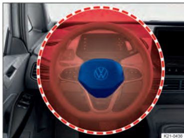
Fig. 25 No lado do condutor: local de instalação e área de expansão do airbag frontal do condutor.
