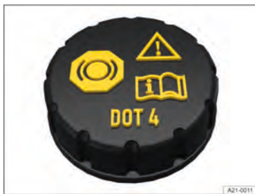
Fig. 195 No compartimento dianteiro: tampa do reservatório do fluido de freio.
