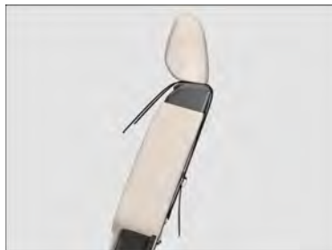
Fig. 40 No lado de trás dos assentos laterais do banco traseiro ou do banco do passageiro dianteiro: cinto de fixação superior preso.
