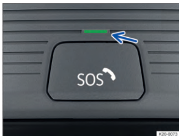
Fig. 46 No console do teto: comando do sistema de chamada de emergência eCall obrigatório por lei (atrás da cobertura dos botões) e luz de controle.
