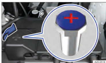
Fig. 181 No compartimento dianteiro sob uma cobertura: ponto de auxílio à partida positivo.
