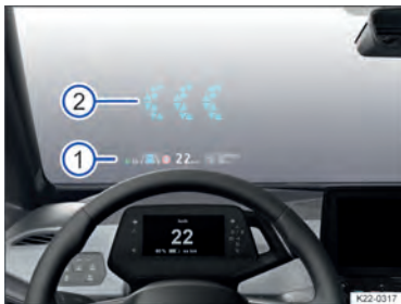
Fig. 14 No campo de visão do condutor: área próxima do HUD ① e AR-HUD ②.
