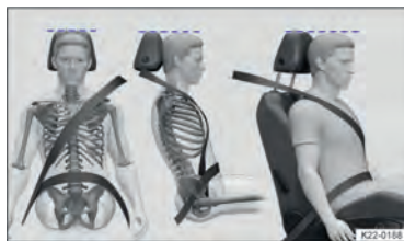
Fig. 22 Posição correta do cadarço do cinto de segurança e ajuste correto do apoio para cabeça.
