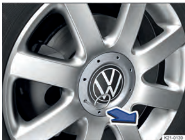
Fig. 200 Retirar a calota central.
