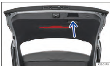
Fig. 61 Na tampa traseira aberta: alça para fechar a tampa traseira (representação esquemática).
