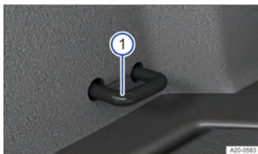
Fig. 138 No compartimento de bagagem: olhal de amarração (representação esquemática).
