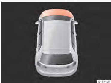
Fig. 191 No display do instrumento combinado: tampa dianteira aberta ou não fechada corretamente (representação esquemática).
