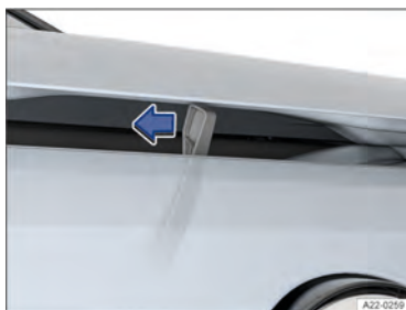
Fig. 188 Na tampa dianteira: alavanca de acionamento.
