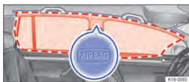
Fig. 32 Em ambos os lados do veículo: local de instalação e área de expansão do airbag para cabeça.
