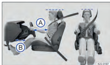
Fig. 17 Representação esquemática: distância correta do condutor em relação ao volante, posição correta do cadarço do cinto de segurança e ajuste correto do apoio para cabeça.
