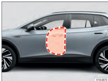
Fig. 31 No interior do veículo, em ambos os lados de veículo: área de expansão do airbag lateral dianteiro.
