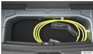
Fig. 164 Sob o assoalho do compartimento de bagagem: porta-objetos do cabo de carregamento (representação esquemática).
