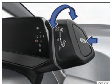
Fig. 96 Seletor da posição de marcha com o botão para o freio de estacionamento eletrônico (seta).
