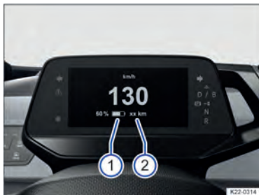
Fig. 12 No instrumento combinado digital: autonomia e indicador de reserva.
