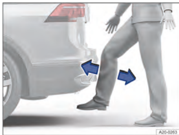
Fig. 64 Representação esquemática da tampa traseira com abertura controlada por sensor (Easy Open).
