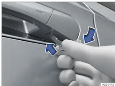
Fig. 55 Maçaneta da porta do condutor: alavancar a capa de cobertura para fora.
