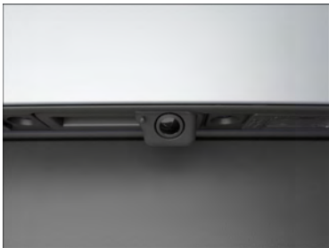
Fig. 214 Na traseira do veículo: câmera de marcha a ré no botão da alça (representação esquemática).
