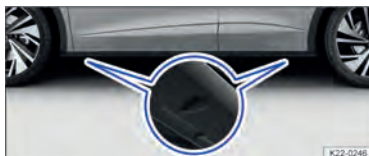
Fig. 205 Pontos de apoio do macaco.
