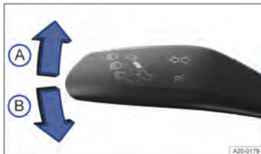
Fig. 83 À esquerda na coluna de direção: alavanca dos indicadores de direção e do farol alto.
