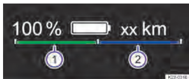
Fig. 13 No instrumento combinado digital: indicador de potência (representação esquemática).
