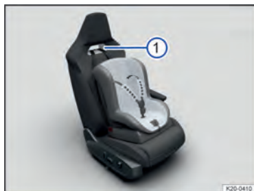
Fig. 41 No encosto do banco esportivo premium no lado do passageiro dianteiro: abertura do cinto de fixação superior (representação esquemática).
