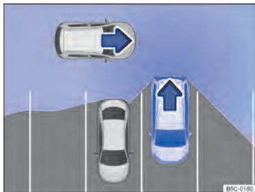
Fig. 123 Representação esquemática do assistente de saída de vaga: área monitorada ao redor do veículo.
