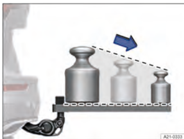
Fig. 145 Distribuição de peso recomendada no sistema de bagageiro traseiro
