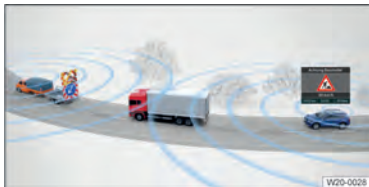
Fig. 126 Representação esquemática: alerta de perigos no trânsito devido a um canteiro de obras diurno ou móvel.
