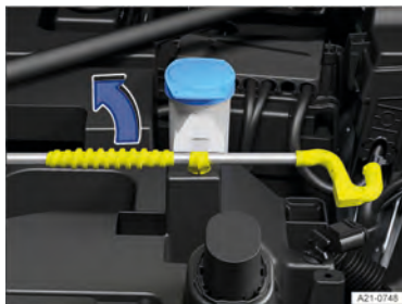
Fig. 189 No compartimento frontal: haste de sustentação da tampa no suporte.
