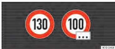
Fig. 16 No display do instrumento combinado: exemplo para limites de velocidade detectadas com sinais adicionais genéricos.
