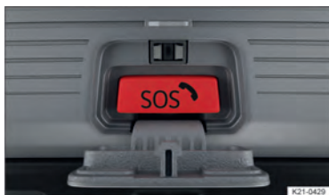
Fig. 47 No console do teto: botão do sistema de chamada de emergência eCall obrigatório por lei.
