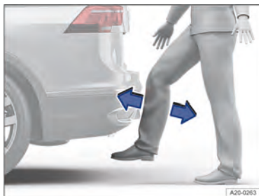
Fig. 65 Representação esquemática da tampa traseira com fechamento controlado por sensor (Easy Close).
