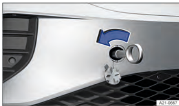
Fig. 184 No para-choque dianteiro à direita: rosquear a argola de reboque.
