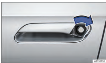
Fig. 56 Travar emergencialmente a porta do condutor.
