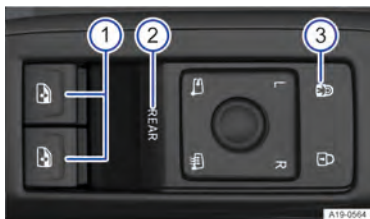
Fig. 66 Na porta do condutor: botões dos vidros elétricos dianteiros e traseiros.
