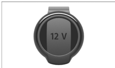
Fig. 125 No compartimento de bagagem do lado esquerdo: tomada 12 V articulada (representação esquemática).
