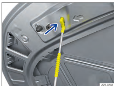
Fig. 190 Na tampa dianteira: alojamento para a haste de sustentação da tampa (representação esquemática).
