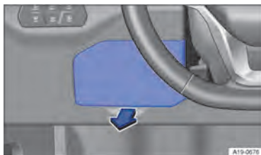
Fig. 175 No lado do condutor: cobertura da caixa de fusíveis no painel de instrumentos (veículos com direção à esquerda).
