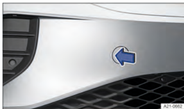
Fig. 183 No para-choque dianteiro à direita: retirar cobertura.
