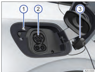
Fig. 154 Atrás da tampa do carregamento da bateria traseira direita: tomada de carregamento.
