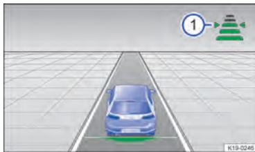
Fig. 106 No display do instrumento combinado: distância regulada , o ACC está regulando (representação esquemática).
