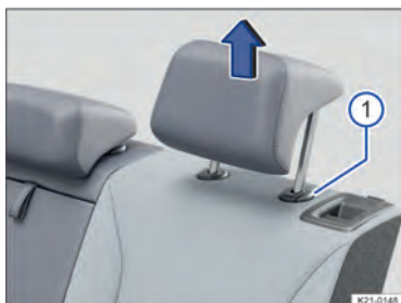
Fig. 76 Representação esquemática: remover o apoio para cabeça traseiro.
