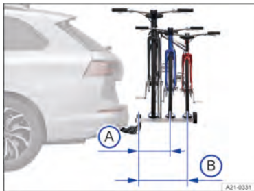
Fig. 146 Representação esquemática da largura máxima de um suporte de bicicletas para duas ou três bicicletas.
