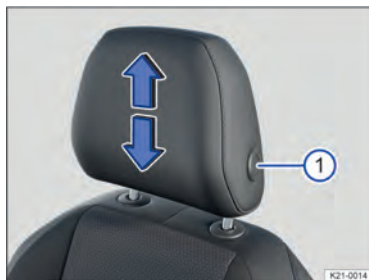
Fig. 73 Representação esquemática: ajustar o apoio para cabeça dianteiro.
