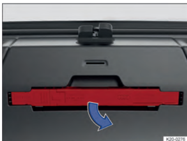
Fig. 42 Na tampa traseira: suporte para o triângulo de segurança.
