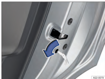
Fig. 57 Na parte dianteira da porta traseira direita: travamento de emergência do veículo com a chave de emergência (representação esquemática).
