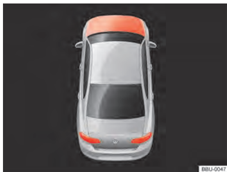
Fig. 169 No display do instrumento combinado: tampa dianteira aberta ou não fechada corretamente (representação esquemática).
