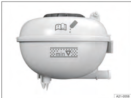
Fig. 176 No compartimento do motor: marcações no reservatório de expansão do líquido de arrefecimento (representação esquemática).
