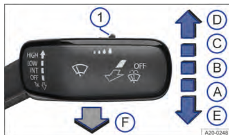
Fig. 86 À direita da coluna de direção: comandar os limpadores do para-brisa.
