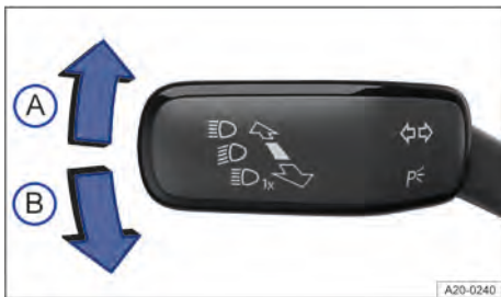
Fig. 81 À esquerda na coluna de direção: alavanca dos indicadores de direção e do farol alto.
