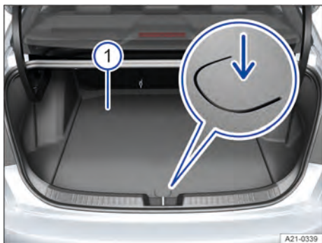
Fig. 140 No compartimento de bagagem: abrir o assoalho do compartimento de bagagem.
