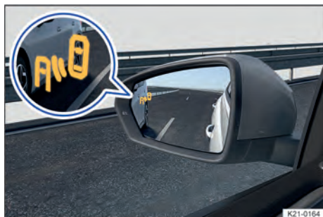
Fig. 125 Nos espelhos retrovisores externos: indicação do sensor de ponto cego.
