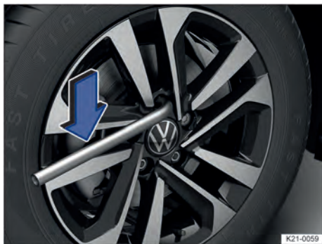
Fig. 196 Troca de roda: desaparafusar os parafusos de roda com a chave de roda.
