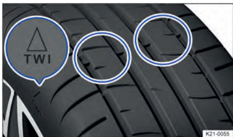
Fig. 182 Perfil do pneu: indicador de desgaste.
