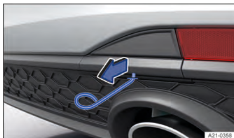
Fig. 163 No para-choque traseiro à direita: desmontar a cobertura da variante 2.
