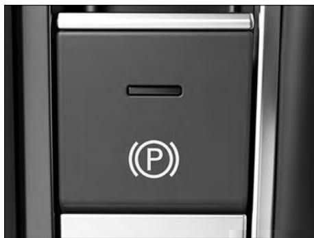
Fig. 126 No console central: botão do freio de estacionamento eletrônico.
