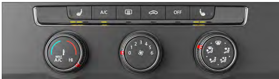
Fig. 93 Na parte superior do console central: painel de comando do ar-condicionado do ar-condicionado manual.
