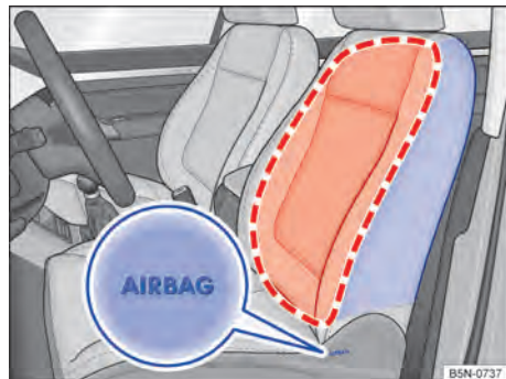
Fig. 36 Lateralmente em ambos os bancos dianteiros: local de instalação e área de expansão do airbag lateral.
