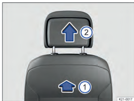
Fig. 74 Representação esquemática: remover o apoio para cabeça dianteiro.
