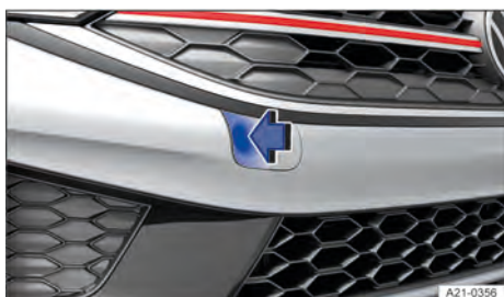
Fig. 158 No para-choque dianteiro à direita: desmontar a cobertura da variante 2.
