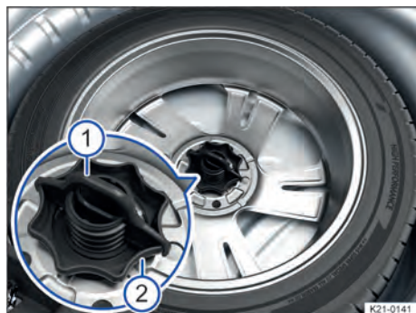
Fig. 189 No compartimento de bagagem: manípulo para fixação da roda sobressalente.
