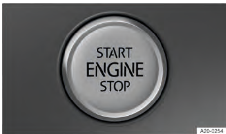
Fig. 100 Na parte inferior do console central: botão de partida para dar partida no motor.
