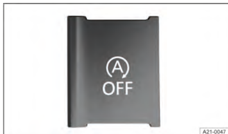
Fig. 102 Na parte inferior do console central ou, dependendo da versão, no sistema Infotainment: botão do sistema Start-Stop.
