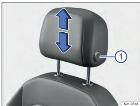
Fig. 72 Representação esquemática: ajustar o apoio para cabeça dianteiro.
