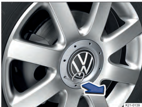
Fig. 183 Retirar a calota central.
