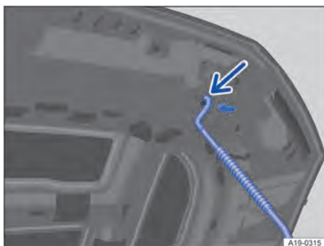
Fig. 168 Na tampa dianteira: alojamento para a haste de sustentação da tampa (representação esquemática).
