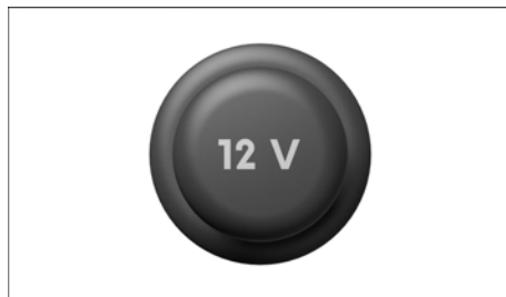
Fig. 135 Na parte dianteira do console central: tomada 12 V com cobertura removível (representação esquemática).
