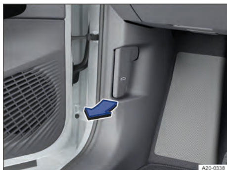
Fig. 165 Na área para os pés no lado do condutor: alavanca de destravamento da tampa dianteira (representação esquemática).
