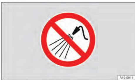
Fig. 198 Placa de advertência: não usar uma lavadora de alta pressão na área designada.
