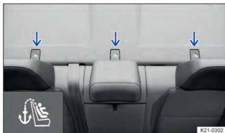
Fig. 43 No porta-objetos atrás do banco traseiro: pontos de ancoragem Top Tether do cinto de segurança Top Tether.
