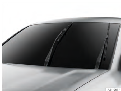
Fig. 146 Limpadores dos vidros na posição de serviço (representação esquemática).
