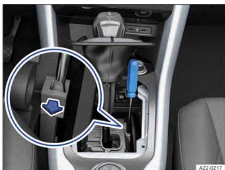
Fig. 108 Destruar emergencialmente o bloqueio da alavanca seletora (variante 2).
