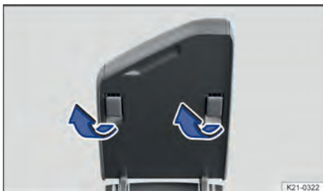
Fig. 77 Apoio de plástico do descanso-braço central.
