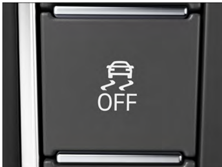
Fig. 133 No console central: botão para desligar e ligar manualmente o ASR, e o ESC Sport (dependendo da versão).
