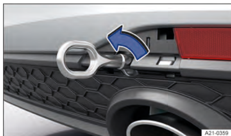
Fig. 164 No para-choque traseiro à direita: rosquear a argola de reboque da variante 2.
