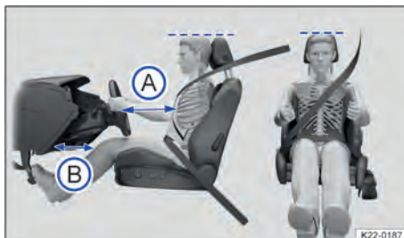
Fig. 24 Representação esquemática: distância correta do condutor em relação ao volante, posição correta do cadarço do cinto de segurança e ajuste correto do apoio para cabeça.
