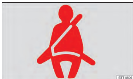
Fig. 25 No display do instrumento combinado: luz de advertência.
