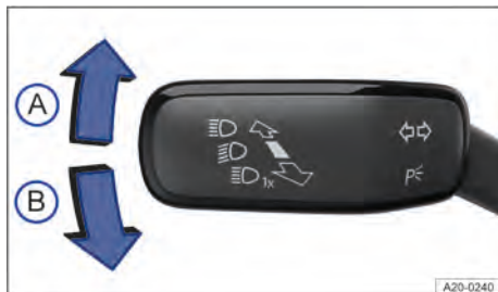
Fig. 84 À esquerda na coluna de direção: alavanca dos indicadores de direção e do farol alto.
