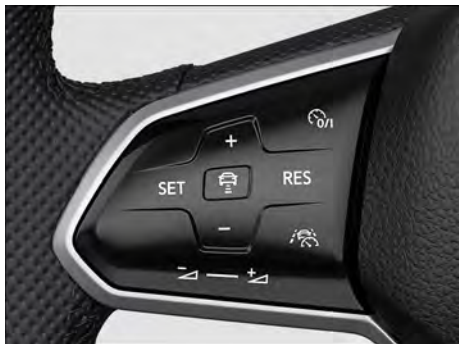
Fig. 124 Lado esquerdo do volante multifunções (variante 2).
