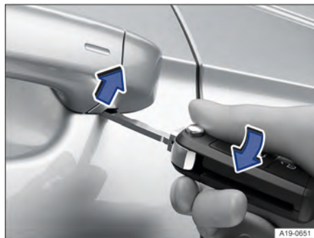
Fig. 57 Maçaneta da porta do condutor: alavancar a capa de cobertura para fora.
