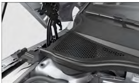
Fig. 199 Entre o compartimento do motor e o para-brisa: caixa de água (representação esquemática).
