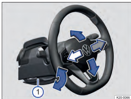
Fig. 65 Embaixo do volante no revestimento da coluna de direção: alavanca de ajuste mecânico da posição do volante (representação esquemática).
