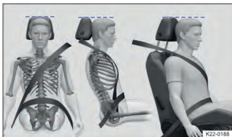
Fig. 28 Posição correta do cadarço do cinto de segurança e ajuste correto do apoio para cabeça.
