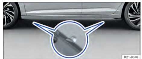
Fig. 190 Pontos de apoio do macaco (variante 1).
