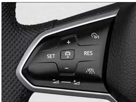
Fig. 119 Lado esquerdo do volante multifunções (variante 2).
