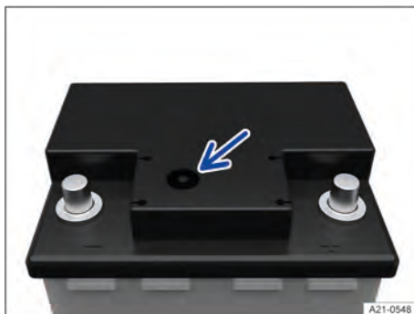
Fig. 178 No lado superior da bateria do veículo 12 V: visor de inspeção da bateria (representação esquemática).
