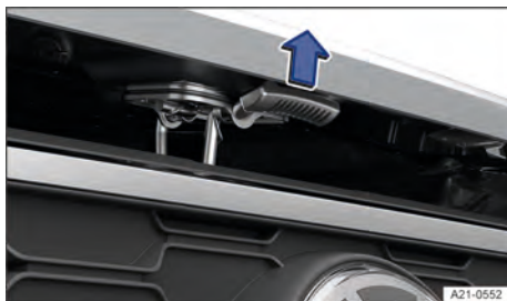
Fig. 166 Acima da grade do radiador: alavanca de comando da tampa dianteira (representação esquemática).
