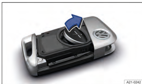
Fig. 53 Chave do veículo: trocar a pilha-botão.
