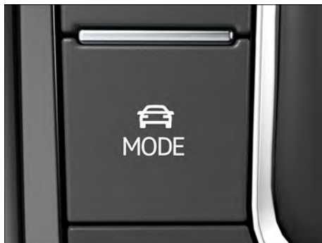
Fig. 109 No console central: botão MODE na seleção do perfil de condução.
