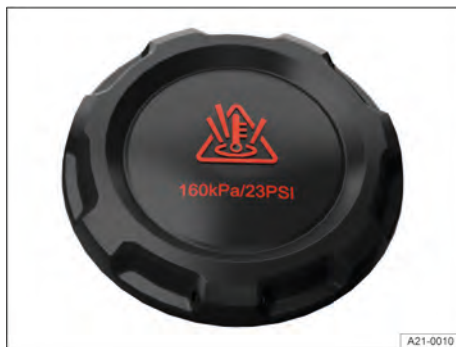
Fig. 175 No compartimento do motor: tampa do reservatório de expansão do líquido de arrefecimento (representação esquemática).
