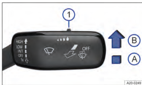
Fig. 87 À direita da coluna de direção: alavanca dos limpadores dos vidros.
