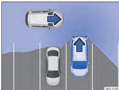
Fig. 131 Representação esquemática do assistente de saída de vaga: área monitorada ao redor do veículo.
