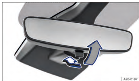
Fig. 89 No para-brisa: espelho retrovisor interno com antiofuscante manual.
