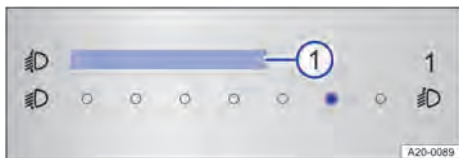
Fig. 85 No sistema Infotainment: regulador touch para regulagem do alcance do farol.
