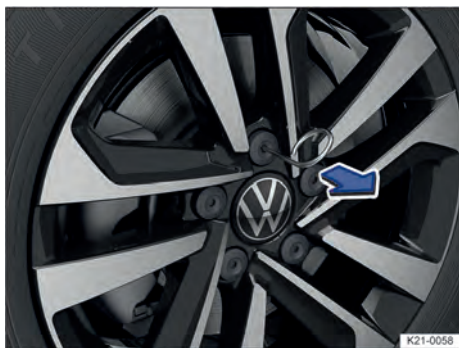
Fig. 185 Remover as capas de cobertura dos parafusos de roda.
