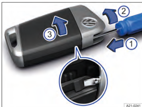
Fig. 52 Chave do veículo: abrir a tampa do compartimento da bateria.
