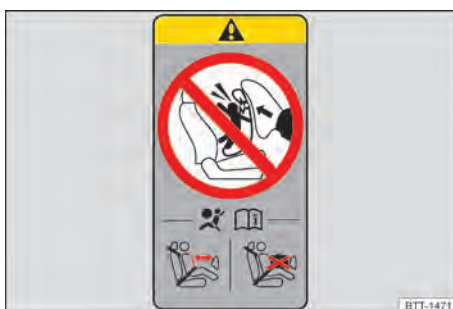
Fig. 41 Representação esquemática: etiqueta do airbag na coluna B.
