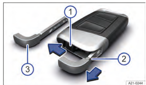
Fig. 50 Chave do veículo: destravamento da chave de emergência (representação esquemática).
