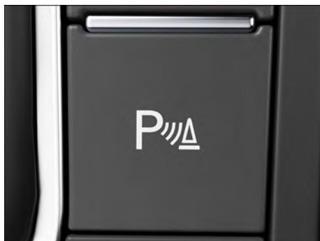
Fig. 129 No console central: botão do auxílio de estacionamento.
