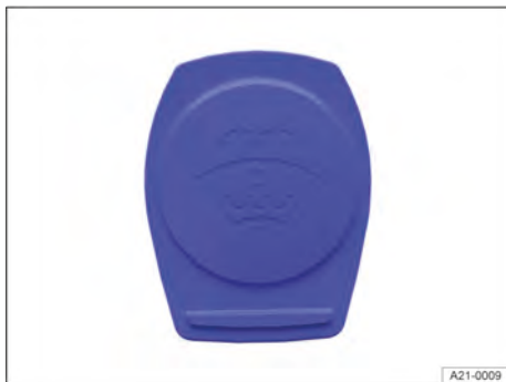
Fig. 170 No compartimento do motor: tampa do reservatório de água dos lavadores dos vidros (representação esquemática).
