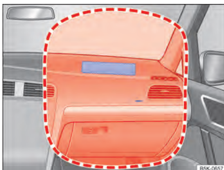
Fig. 32 No lado do passageiro dianteiro: local de instalação e área de expansão do airbag frontal do passageiro dianteiro.
