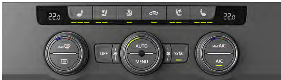
Fig. 92 Na parte superior do console central: painel de comando do ar-condicionado do Climatronic.
