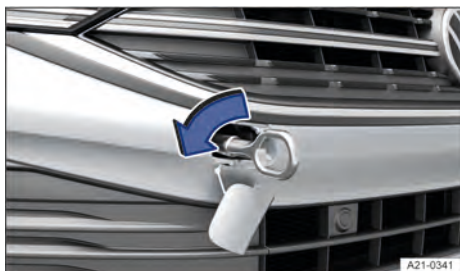
Fig. 159 No para-choque dianteiro à direita: rosquear a argola de reboque da variante 1.
