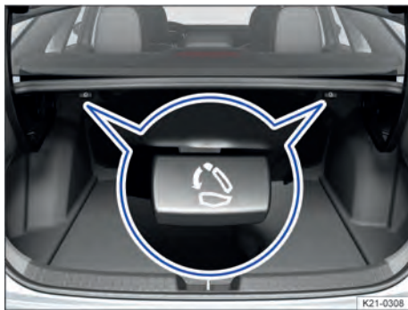
Fig. 70 No compartimento de bagagem: alavanca de destravamento.
