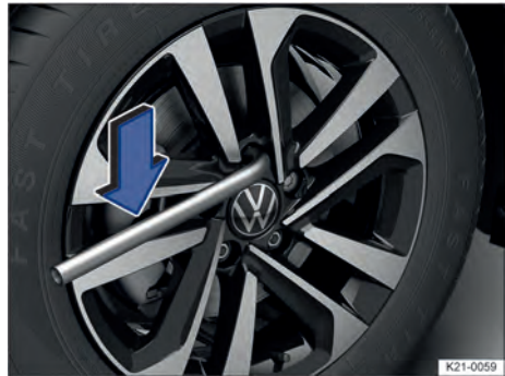
Fig. 186 Troca de roda: afrouxar os parafusos de roda.
