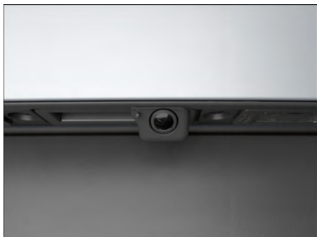
Fig. 200 Na traseira do veículo: câmera de marcha a ré no botão da alça (representação esquemática).
