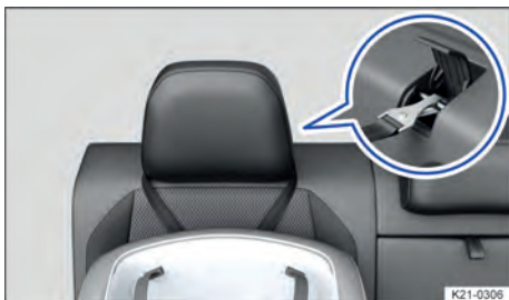
Fig. 45 No encosto do banco traseiro: posição do cinto de segurança no caso de apoios para cabeça não ajustáveis com cinto Top Tether em forma de V.
