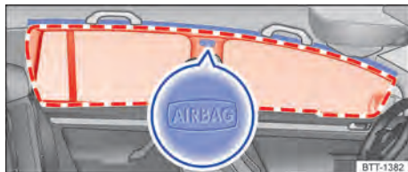
Fig. 38 Em ambos os lados do veículo: local de instalação e área de expansão do airbag para cabeça.
