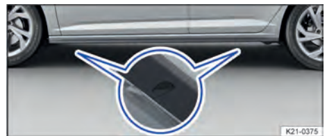
Fig. 191 Pontos de apoio do macaco (variante 2).
