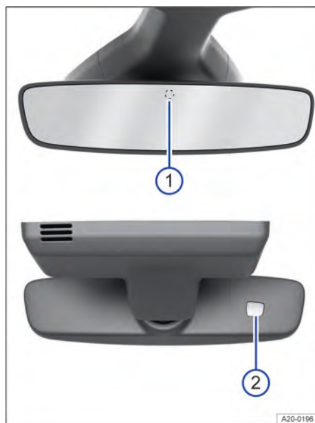
Fig. 88 No para-brisa: espelho retrovisor interno com antiofuscante automático.
