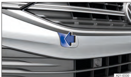
Fig. 157 No para-choque dianteiro à direita: desmontar a cobertura da variante 1.
