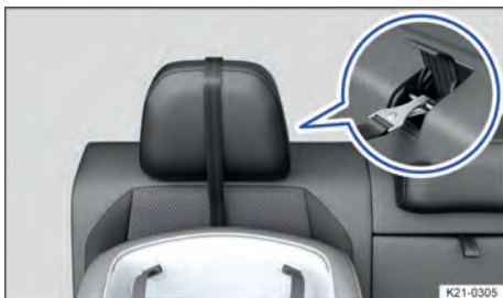
Fig. 44 No encosto do banco traseiro: posição do cinto de segurança no caso de apoios para cabeça não ajustáveis com cinto individual Top Tether.
