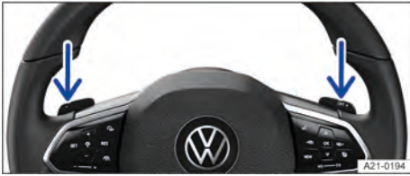
Fig. 106 Volante com seletores basculantes do Tiptronic.
