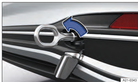
Fig. 162 No para-choque traseiro à direita: rosquear a argola de reboque da variante 1.
