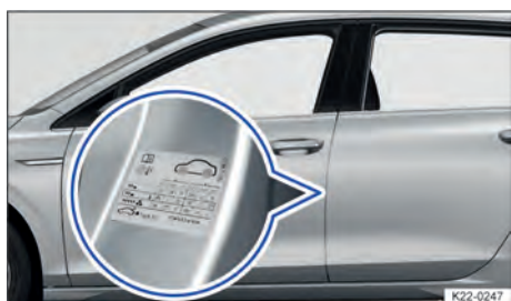
Fig. 180 Na coluna do condutor: etiqueta com as pressões dos pneus (alternativa ao lado interno da portinhola do tanque).
