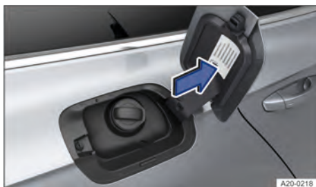
Fig. 142 No lado interno da portinhola do tanque: placa de indicação de combustível (representação esquemática).
