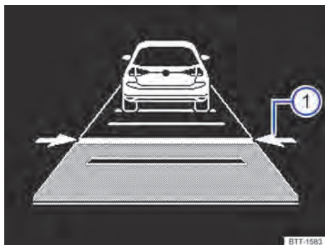
Fig. 120 No display do instrumento combinado: distância regulada ① (representação esquemática, o ACC está regulando).
