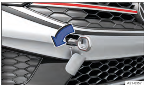
Fig. 160 No para-choque dianteiro à direita: rosquear a argola de reboque da variante 2.
