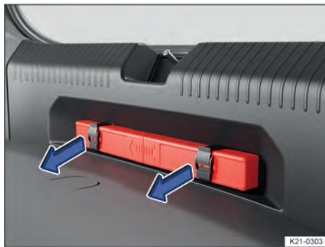
Fig. 46 Embaixo do canto do compartimento de carga: suporte para o triângulo de segurança.
