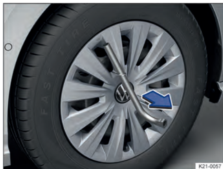
Fig. 184 Retirar a calota integral.
