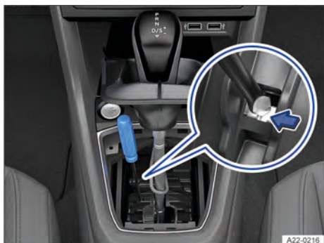
Fig. 107 Destruar emergencialmente o bloqueio da alavanca seletora (variante 1).
