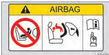
Fig. 40 Representação esquemática: etiqueta do airbag no para-sol.
