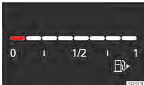
Fig. 16 Indicador do nível de combustível no instrumento combinado digital Basic (representação esquemática).
