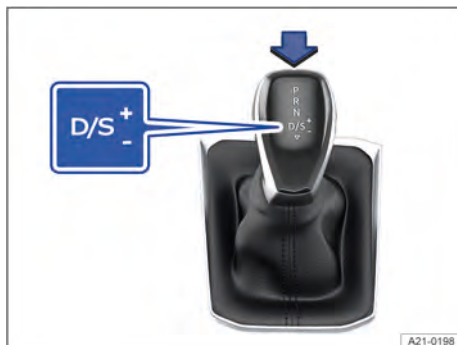
Fig. 104 Alavanca seletora da transmissão automática com botão bloqueador (seta).
