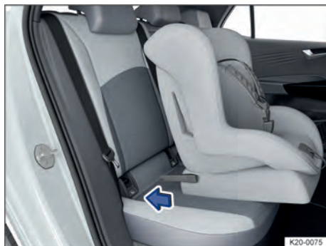
Fig. 42 Representação esquemática: instalar a cadeira de criança com braços de apoio.
