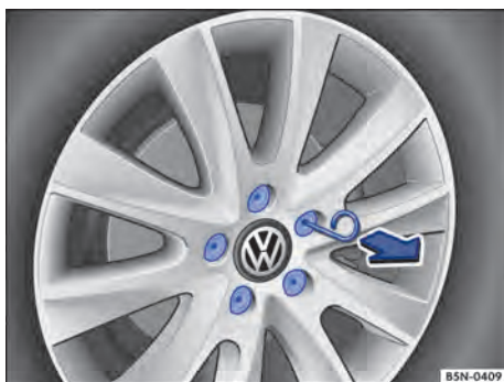
Fig. 168 Remover as capas de cobertura dos parafusos de roda.
