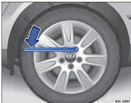
Fig. 169 Troca de roda: soltar os parafusos da roda.
