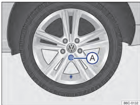
Fig. 172 Troca de roda: sequência de remoção dos parafusos da roda.
