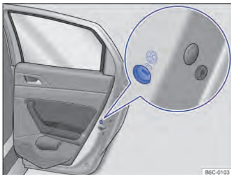
Fig. 51 Na porta traseira (lado direito): localização da trava de segurança para crianças.
