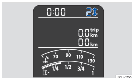
Fig. 87 No instrumento combinado: indicador de troca de marcha (variante 1).
