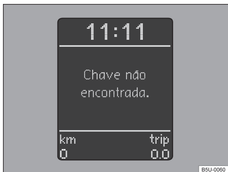
Fig. 91 No instrumento combinado: display com indicação do imobilizador ativado - veículos com Sistema de Informações Volkswagen.
