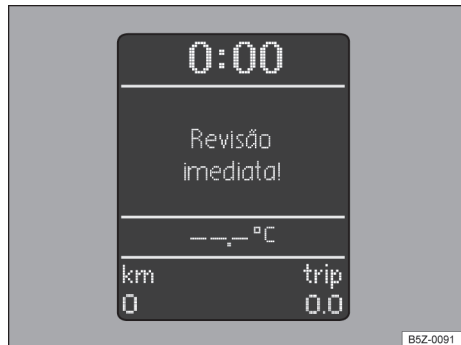
Fig. 18 Display do instrumento combinado: indicador do intervalo de serviço.
