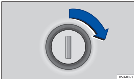
Fig. 54 Cilindro da fechadura para trancar e destrancar a tampa do compartimento de carga.
