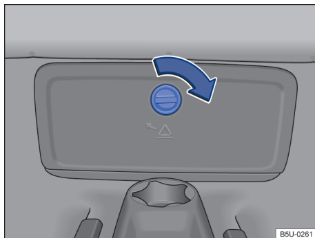
Fig. 135 No assoalho do banco traseiro: acesso à caixa de fixação das ferramentas de bordo.
