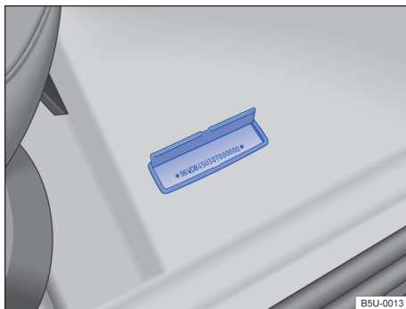
Fig. 188 Em frente ao banco do passageiro: número de identificação do veículo (número do chassi) no assoalho, em frente ao banco do passageiro dianteiro. ▶
