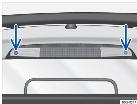
Fig. 150 No compartimento de carga: remover a lanterna de freio elevada.
