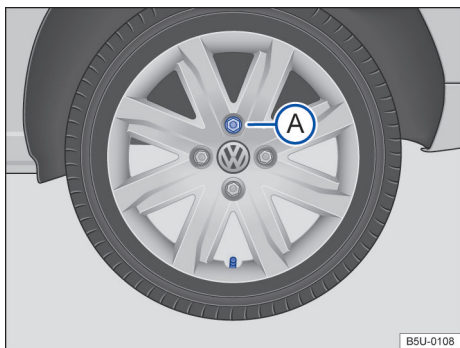
Fig. 182 Troca de roda: sequência de remoção dos parafusos da roda.
