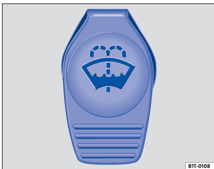
Fig. 162 No compartimento do motor: tampa do reservatório de água dos lavadores do para-brisa.
