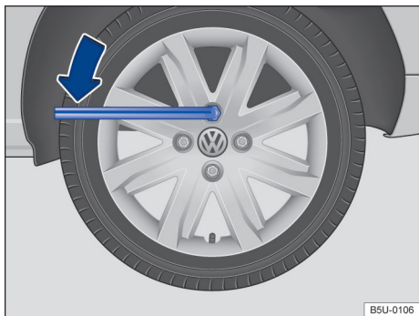
Fig. 179 Troca de roda: soltar os parafusos da roda.
