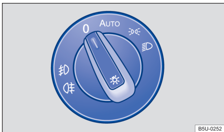
Fig. 71 No painel: interruptor das luzes.
