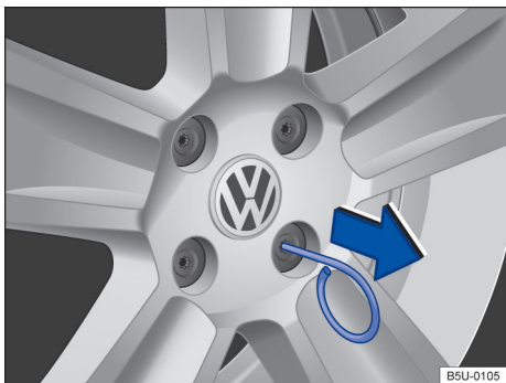
Fig. 177 Retirar as capas de cobertura dos parafusos da roda.
