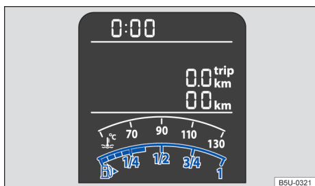
Fig. 14 No display do instrumento combinado: indicador do nível de combustível (variante 1).
