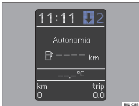
Fig. 88 No instrumento combinado: indicador de troca de marcha (variante 2).
