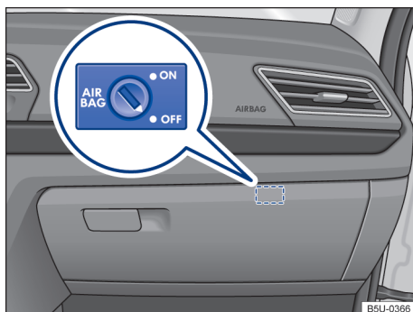
Fig. 38 No porta-luvas: interruptor desacionado pela chave para desligar e ligar o airbag frontal do passageiro.
