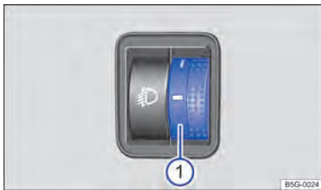
Fig. 76 Ao lado do volante: regulador do alcance do farol ①.
