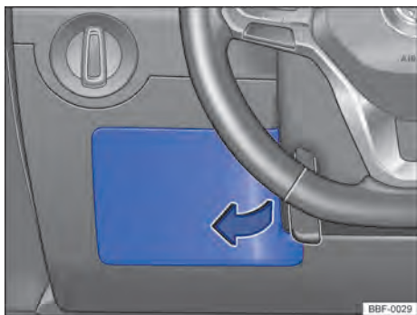
Fig. 143 No lado do condutor do painel de instrumentos: cobertura da caixa de fusíveis.
