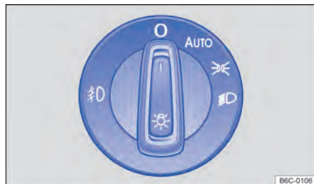
Fig. 74 Ao lado do volante: interruptor de luzes (uma variante).
