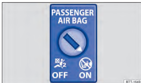
Fig. 36 No painel de instrumentos no lado do passageiro dianteiro: interruptor acionado pela chave para desligar e ligar o airbag frontal do passageiro dianteiro.
