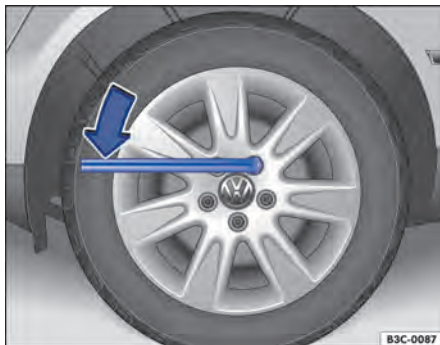
Fig. 172 Troca de roda: soltar os parafusos da roda.
