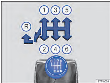
Fig. 94 Esquema de troca de marchas da transmissão manual de 6 marchas.
