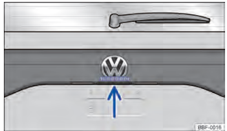
Fig. 59 Na tampa traseira: botão para abrir a tampa traseira.
