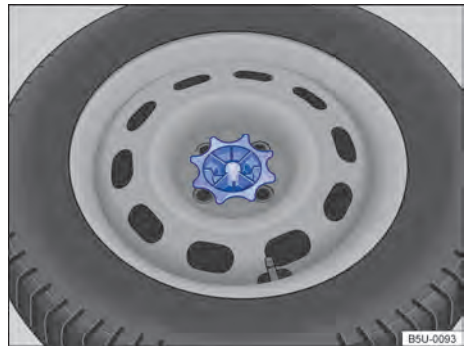
Fig. 169 No compartimento de bagagem: manipulador para fixação da roda de emergência.
