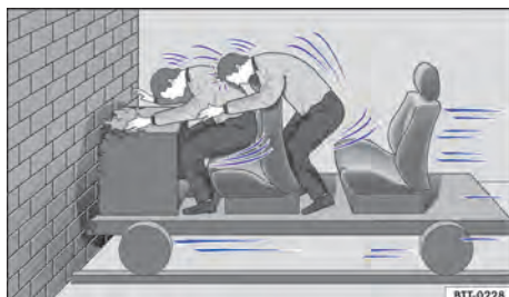
Fig. 24 Um veículo com os ocupantes sem cintos de segurança colide com o muro.
