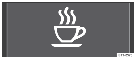
Fig. 16 No display do instrumento combinado: símbolo do sistema de reconhecimento de cansaço.
