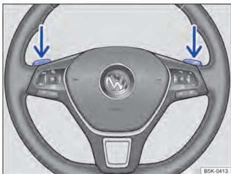
Fig. 97 Volante com seletores basculantes do Tiptronic.
