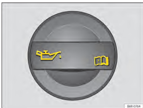
Fig. 159 No compartimento do motor: tampa da abertura para enchimento de óleo do motor.
