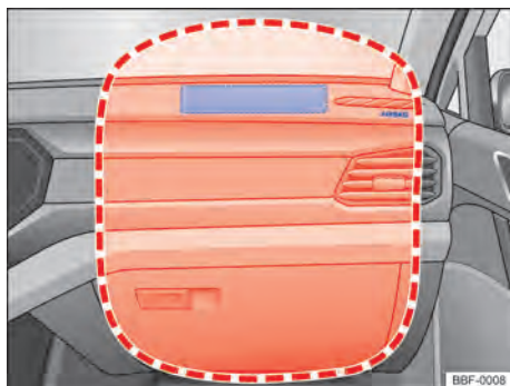
Fig. 35 Local de instalação e área de expansão do airbag frontal do passageiro dianteiro.
