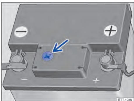
Fig. 163 No compartimento do motor: exemplo de posição do visor no lado superior da bateria do veículo.
