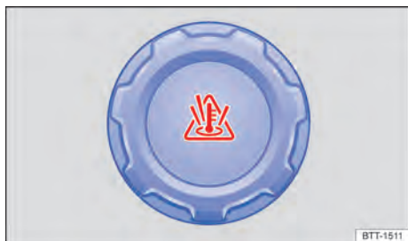
Fig. 161 No compartimento do motor: tampa do reservatório de expansão do líquido de arrefecimento do motor.
