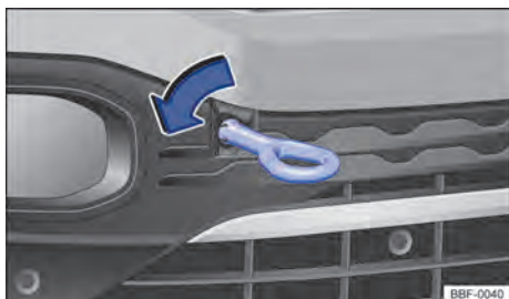
Fig. 153 No para-choque dianteiro à direita: rosquear a argola de reboque.
