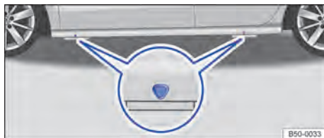
Fig. 174 Pontos de apoio do macaco.
