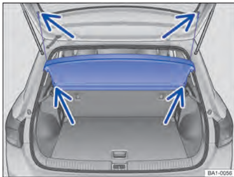
Fig. 127 No compartimento de bagagem: remover e instalar a cobertura do compartimento de bagagem.
