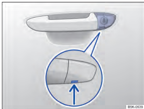
Fig. 54 Maçaneta da porta do condutor: cilindro da fechadura coberto.
